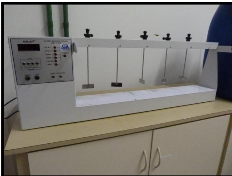
Figura 11 - Aparato de *jar test* utilizado nos testes de coagulação-floculação com quitosana
