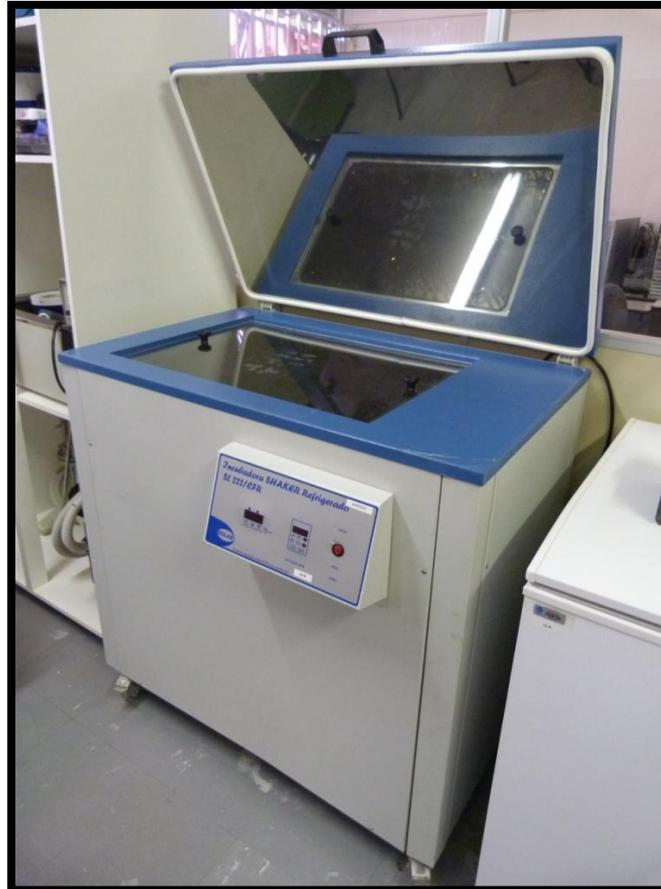
**Figura 10 – Mesa agitadora com controle de temperatura utilizado durante o período de incubação enzimática**
