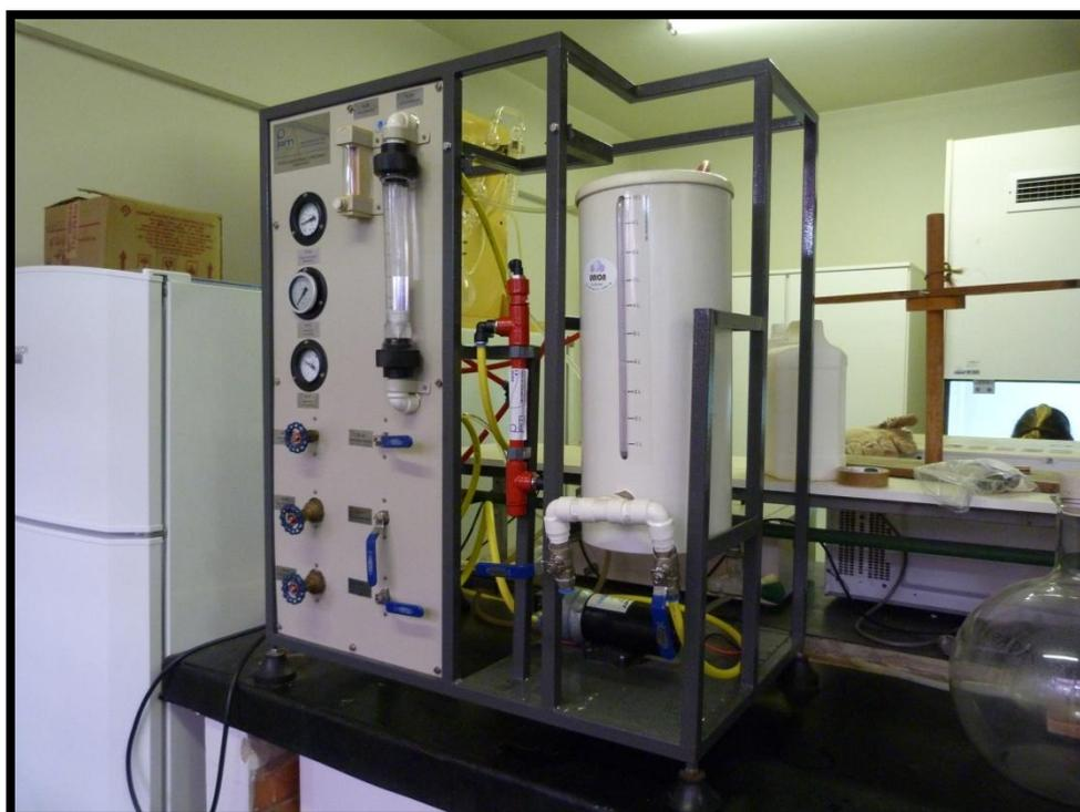
Figura 13 - Módulo de microfiltração
