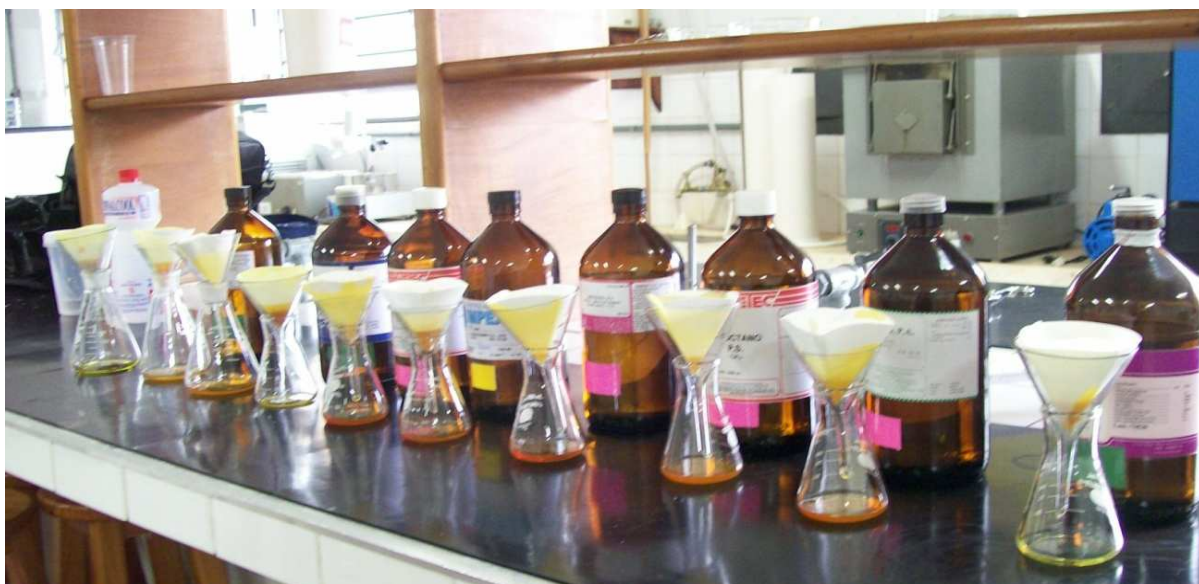
FIGURA 3.3: Etapa de filtração do Teste preliminar.
