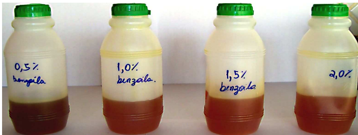
FIGURA 4.4: Potes de polietileno de 300 mL contendo 100 g de lecitina purificada com peróxido de benzoíla nas concentrações de 0,5%, 1,0%, 1,5% e 2,0%, da esquerda para a direita.
