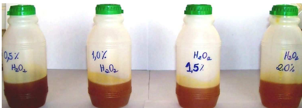
FIGURA 4.3: Potes de polietileno de 300 mL contendo 100 g de lecitina purificada com peróxido de hidrogênio nas concentrações de 0,5%, 1,0%, 1,5% e 2,0%, da esquerda para a direita.
