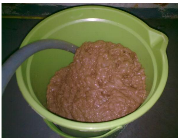
Figura 4.2: Concentrado de apatita onde a água utilizada no teste foi contaminada com 200 ppm de magnésio.
