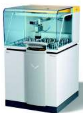
Figura 3.26 – Foto do Espectrômetro Sequencial de Fluorescência de Raios X. ( www.panalytical.com )
