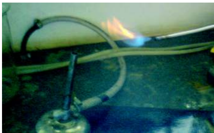
Figura 3.11 – Foto da saída de gases durante a reação de pirólise de casca de castanha de caju. (FEQUI/UFU)
