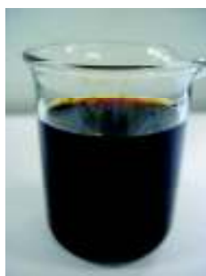
Figura 3.14 – Foto do produto líquido obtido a partir da pirólise de palha de cana-de-açúcar, fase aquosa. (FEQUI/UFU)
