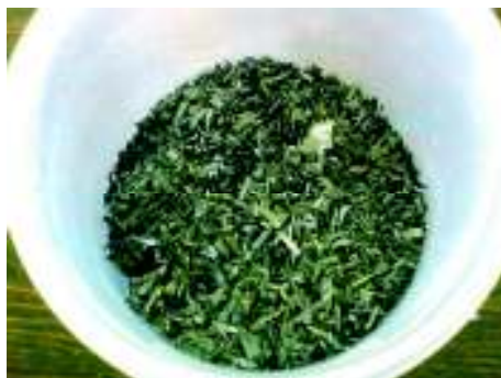
Figura 3.21 – Foto do carvão obtido a partir da pirólise de serragem. (FEQUI/UFU)
