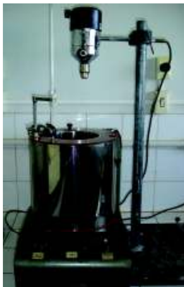
Figura 3.28 – Vaso calorimétrico, agitador e termômetro utilizados nos testes de determinação do poder calorífico superior.
