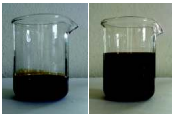
Figura 3.20 – Foto do produto líquido obtido a partir da pirólise de serragem. À esquerda: fase óleo; À direita: fase aquosa. (FEQUI/UFU)
