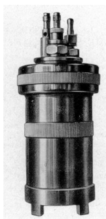
Figura 3.27 – Bomba calorimétrica. (www.ugr.es)
