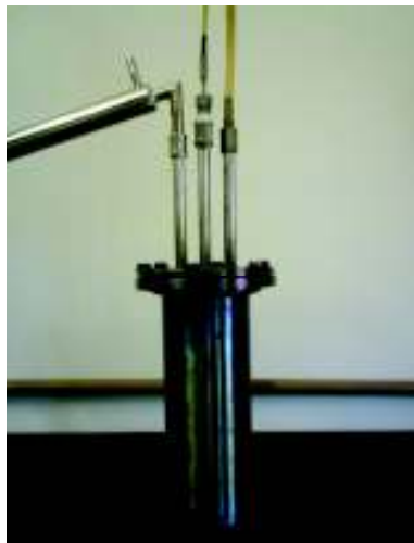
Figura 3.2 – Foto do reator de pirólise. (FEQUI/UFU)
