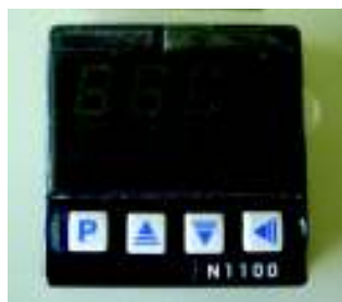
Figura 3.6 – Foto do controlador de temperatura NOVUS N1100. (FEQUI/UFU)
