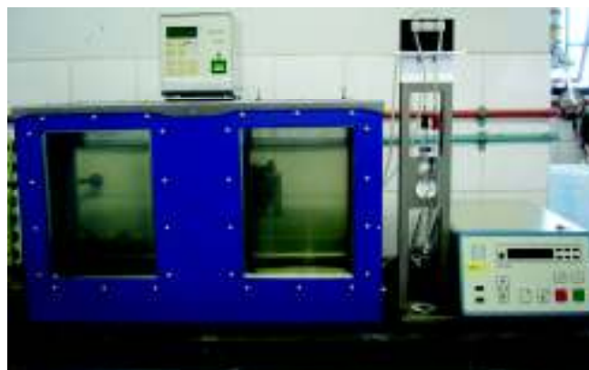
Figura 3.25 – Foto do banho termostaticado ao lado do Viscosímetro Capilar SCHOTT ViscoSystem® AVS 350. (FEQUI/UFU)
