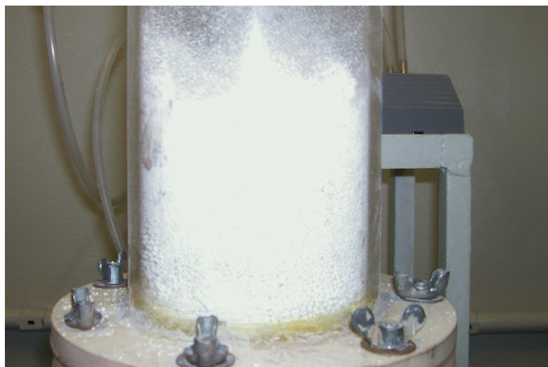
Figura 4.17: Aglomerados formados na fluidização de FCC3.
