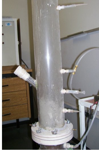
Figura 4.22: Arraste de partículas de R. fosfática.
