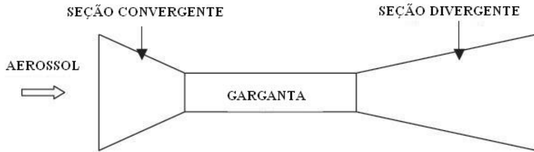
Figura 2.1: Vista esquemática de um lavador Venturi.
