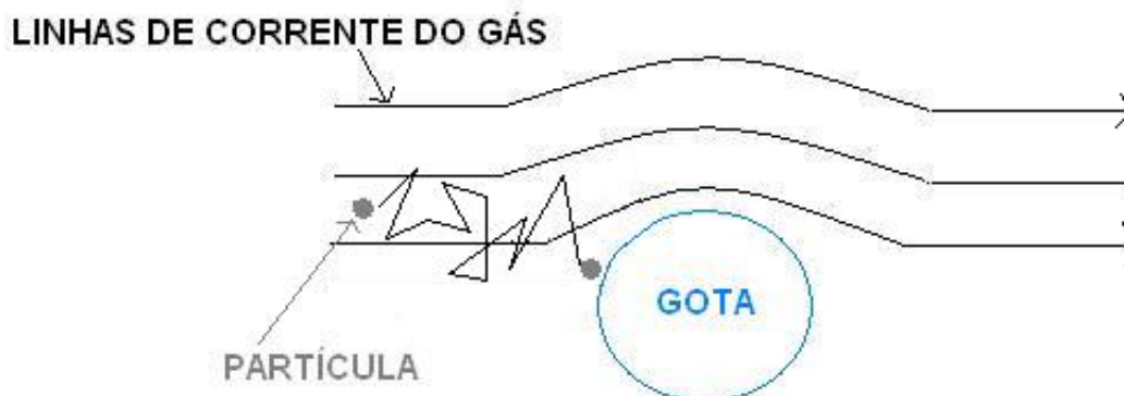
Figura 2.4: Mecanismo de coleta por difusão browniana.
