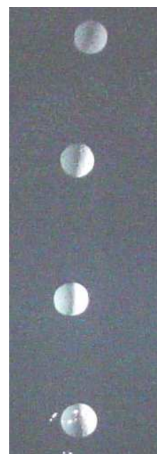
Isopor 4A ( \rho_s = 0,243\text{g/cm}^3 ; d_{\text{médio}} = 2,370\text{cm} ).
