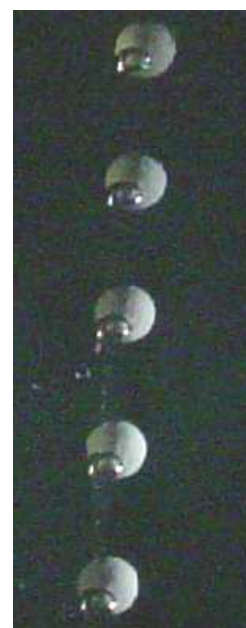
Isopor 4A ( \rho_s = 0,243\text{g/cm}^3 ; d_{\text{médio}} = 2,370\text{cm} ).
