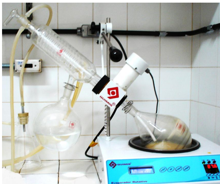
Figura 3.15 – Unidade de concentração de soro purificado.
