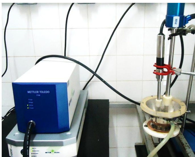
Figura 3.20 – Diagrama esquemático do cristizador de leito vibrado com as sondas do FBRM® e PVM® acopladas.
