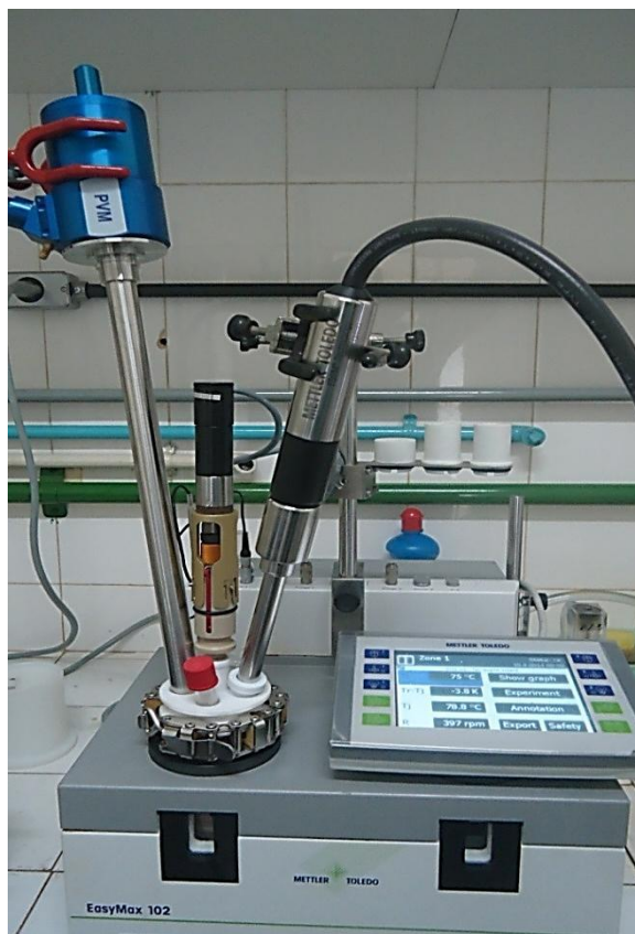
Figura 3.21 – Cristalizador Easymax® com as sondas do FBRM® e PVM® acopladas.
