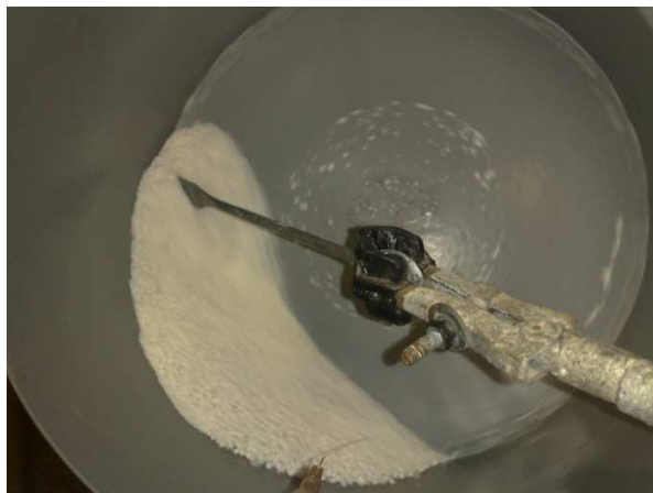
Figura 3.12 - Granulação do TSPG em granulador prato de bancada.
