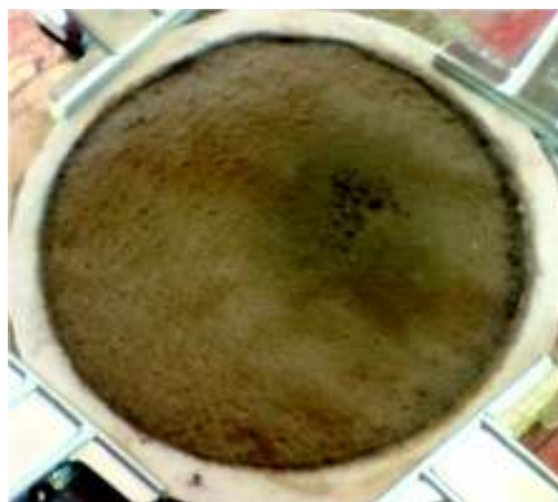
Figura 3.11: Tecido endurecido após embutimento
