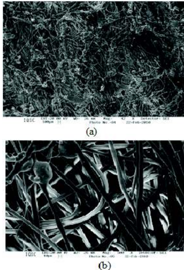
Figura 4.31: Micrografia de um tecido de polipropileno trançado mostrando a forma das fibras, obtida em MEV do IQ/SC - USP, (a) aumento de 50 vezes e (b) aumento de 500 vezes.
