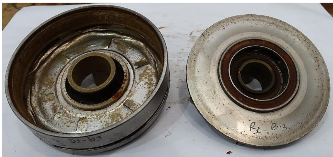
Figura 5.39 – Difusor e rotor do 1º estágio da bomba A após a realização do ensaio de erosão
