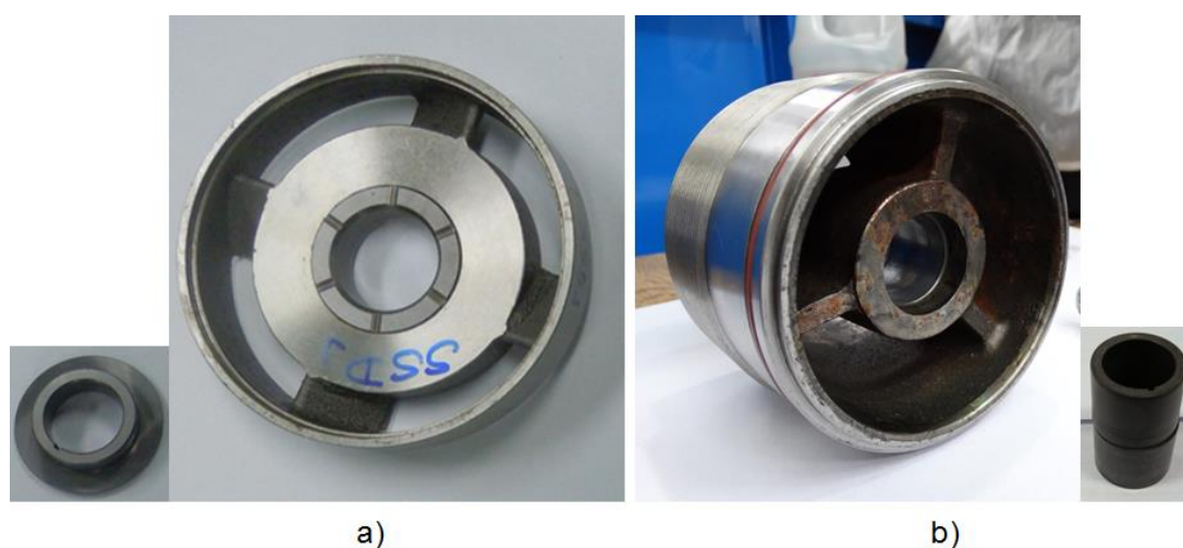
Figura 4.10 – Mancais e luvas da bomba: a) Mancais 1; b) Mancais 2
