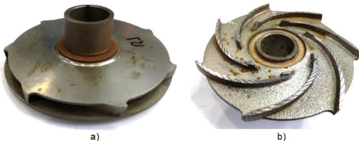
Figura 5.45 – Rotor 1 da bomba B após bombeio de 1033 kg de areia
