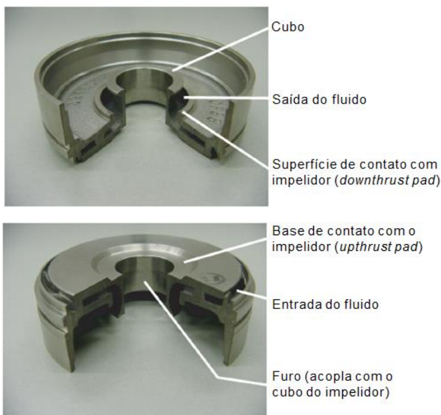
Figura 2.8 – Estrutura do difusor (LAKE, 2006, adaptado)
