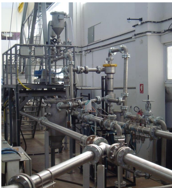
Figura 3.10 – Estrutura atual do Loop 2 com o filtro coletor e o novo reservatório do dosador instalados
