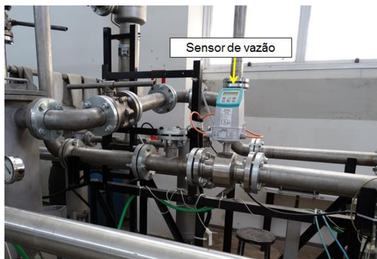
Figura 4.8 – Medidor de vazão eletromagnético instalado no circuito de testes, antes da sucção da bomba
