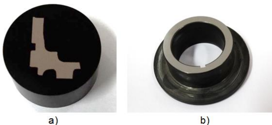
Figura 4.12 – Amostras do difusor e da luva do mancal 1 da Bomba B após o processo de preparação metalográfica: a) Seção do difusor 1 embutida em baquelite; b) Luva do mancal 1 com a superfície do topo polida.
