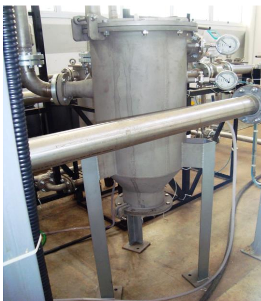
Figura 3.5. Filtro coletor de areia instalado no circuito de testes Loop 2
