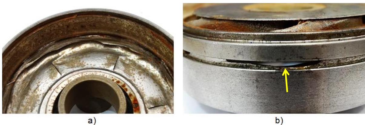
Figura 5.40 – Desgaste erosivo no difusor da bomba A: a) Vista interna; b) Vista externa
