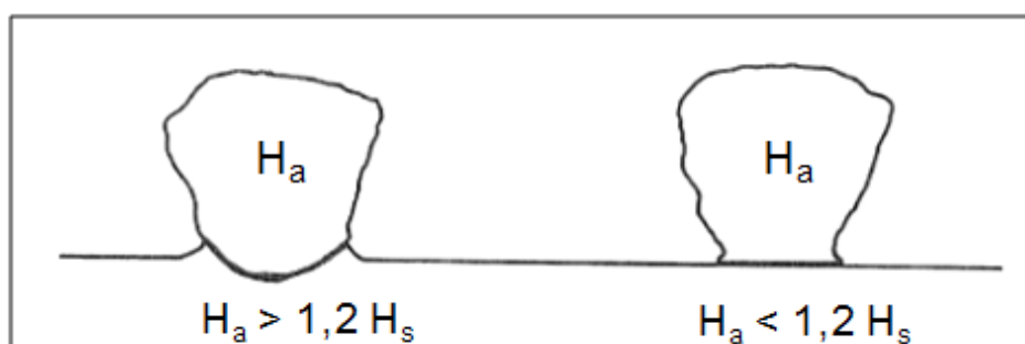
Figura 2.20 – Contato entre uma partícula discreta e uma superfície plana (HUTCHINGS, 1996)
