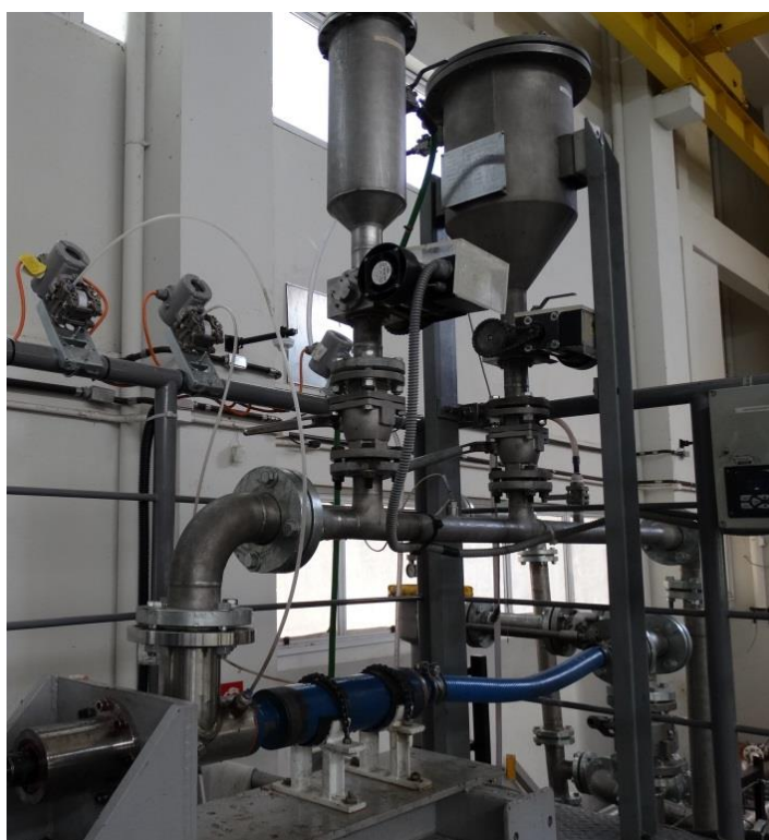
Figura 2.30 – Bomba centrífuga montada na posição horizontal no Loop 2
