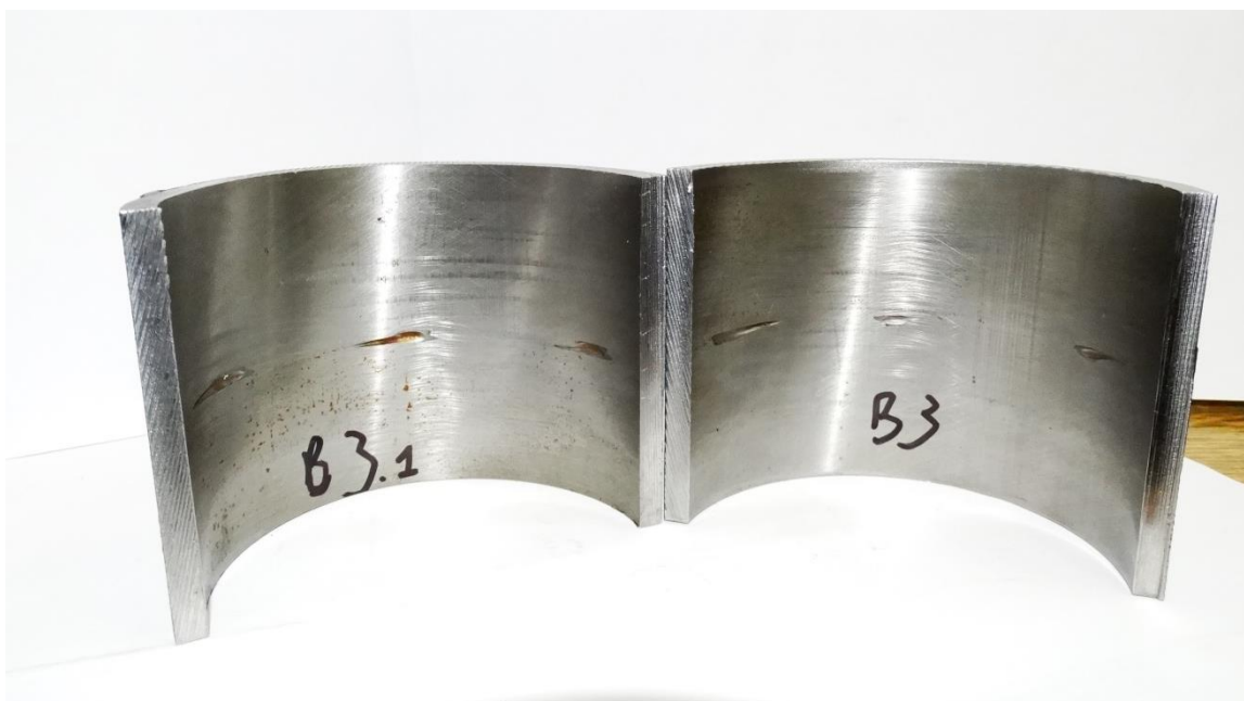
Figura 5.41 - Região da carcaça da bomba A onde estava acomodado o 1º estágio
