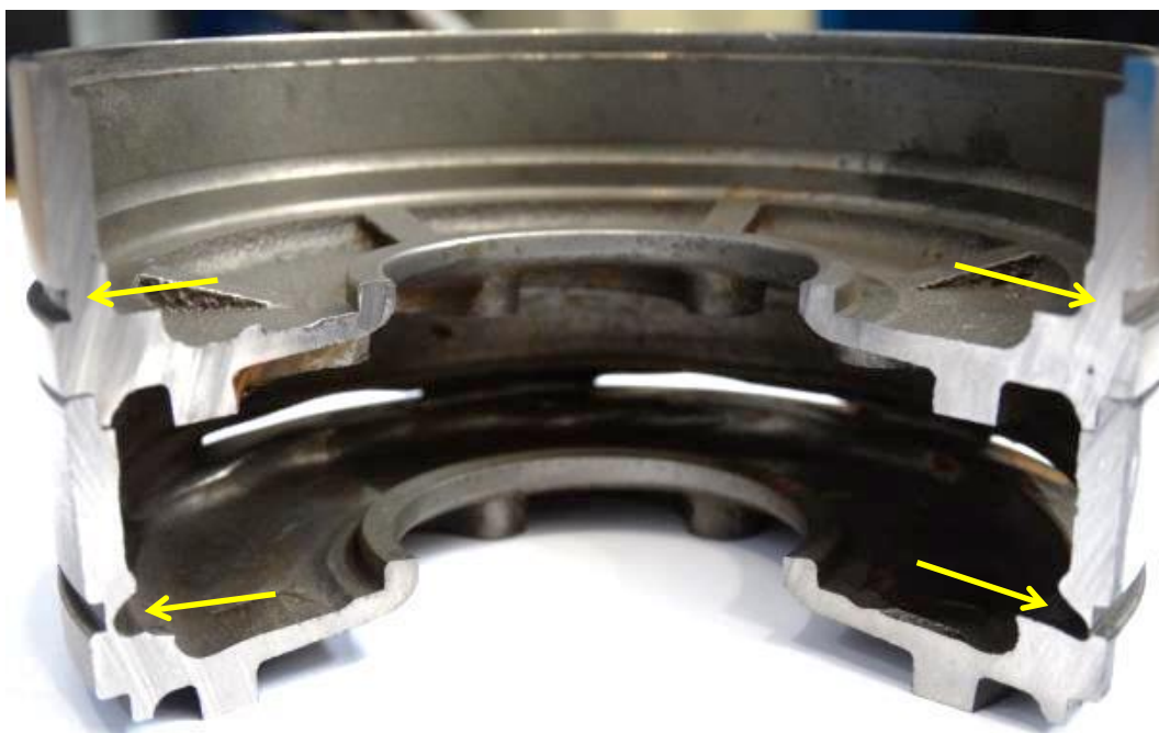
Figura 5.42 - Comparação entre o perfil do difusor do 1º estágio da bomba A (inferior) e um difusor novo (superior). As setas indicam o local desgastado no difusor e os correspondentes locais no difusor novo
