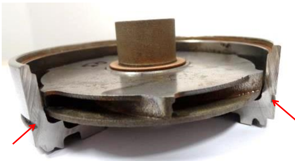
Figura 5.46 – Primeiro estágio da bomba B após bombeio de 1033 kg de areia
