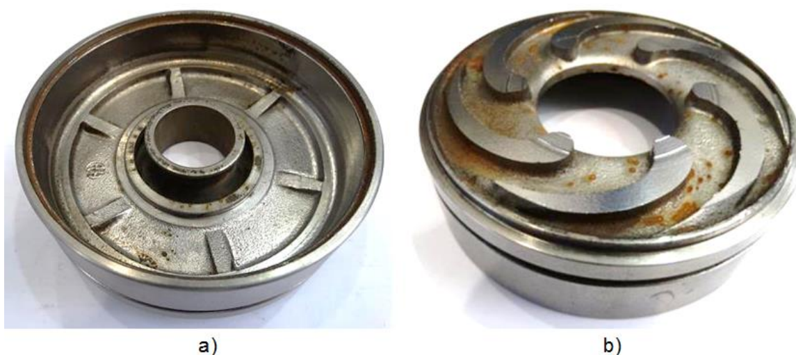
Figura 5.44 – Difusor 1 da bomba B após bombeio de 1033 kg de areia
