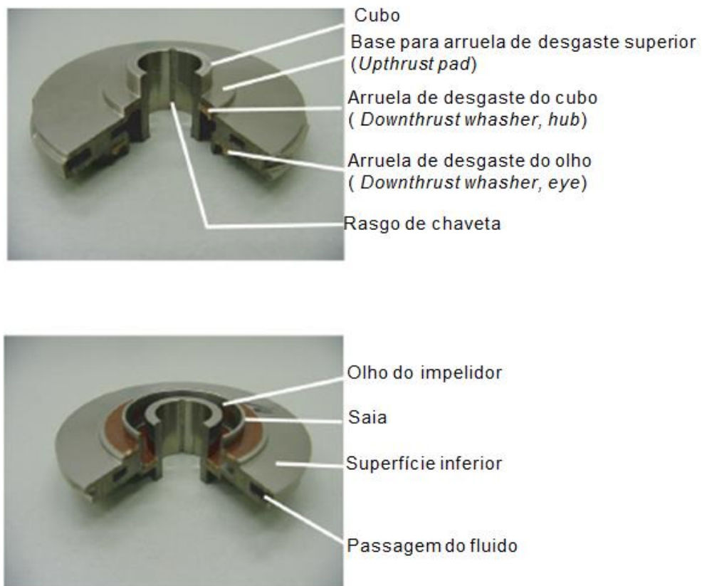
Figura 2.6 – Estrutura do impelidor (LAKE, 2006, adaptado)
