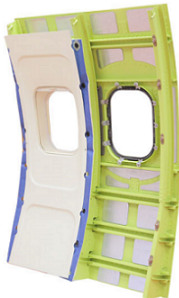
Figura 1.9 – Aplicação de materiais viscoelásticos em aeronaves (extraído de SMAC (2014)).
