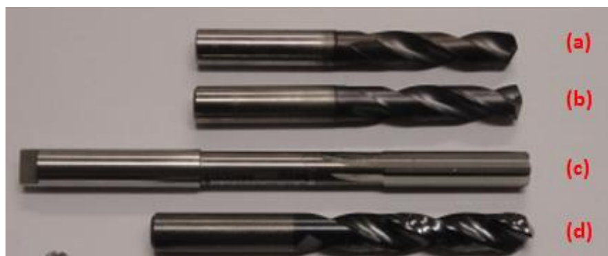
Figura 3.4 – Ferramentas de metal duro inteiriço utilizado nos experimentos: (a) Broca de \varnothing 9,5 mm; (b) Broca de \varnothing 9,7 mm; (c) Alargador de \varnothing 10 mm; (d) Broca especial de \varnothing 10 mm.
