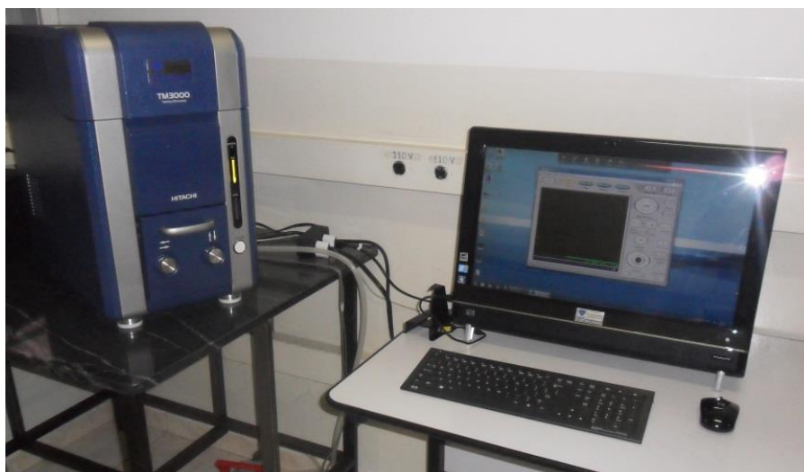
Figura 3.13 – MEV de bancada modelo TM 3000, utilizado para visualização dos desgastes das ferramentas e identificação dos mecanismos de desgaste.
