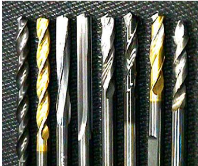
Figura 2.12 – Brocas especiais com diferentes tipos de revestimentos (Noauri, 2005).
