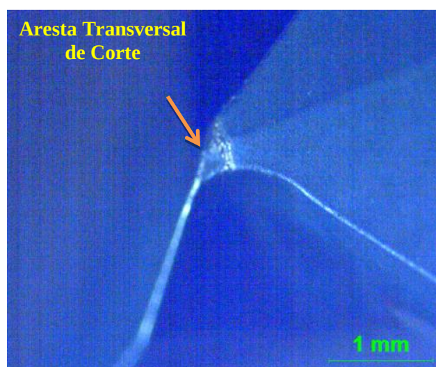
Figura 4.11 – Aresta transversal de corte broca Ø 9,7 mm
