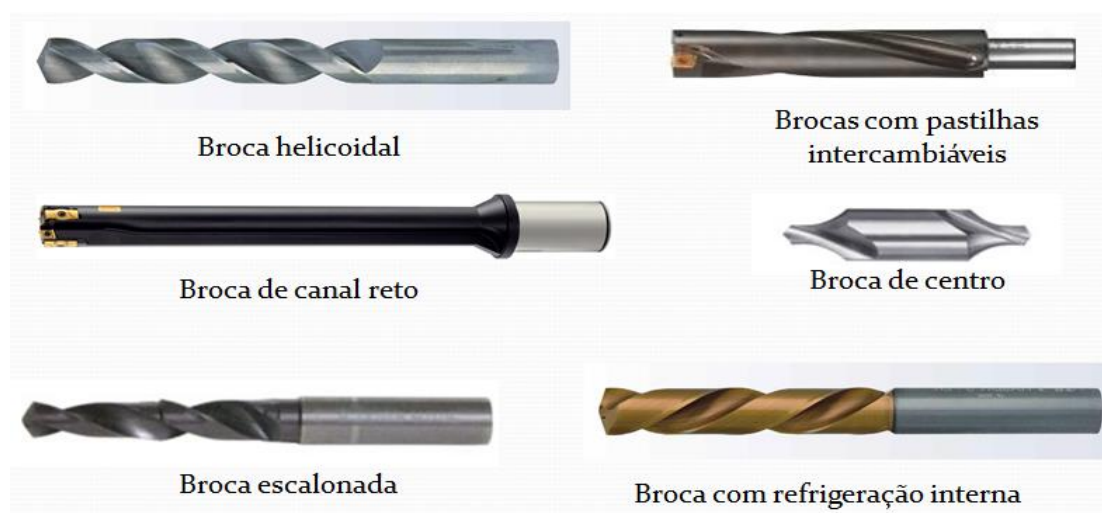
Figura 2.2 – Diferentes tipos de brocas para furação (Adaptado de Stemmer, 2005).
