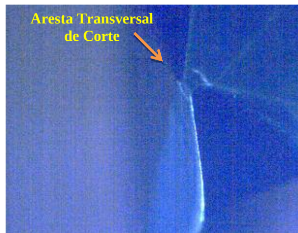
Figura 4.14 – Aresta transversal de corte da broca especial Ø 10 mm
