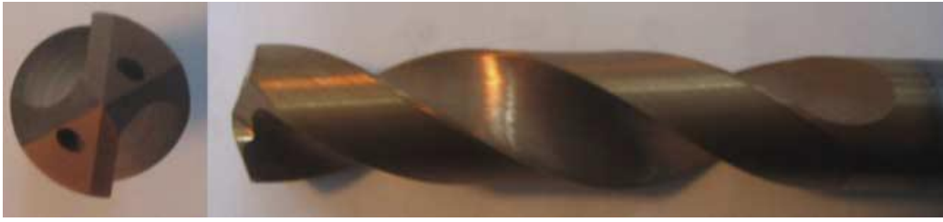
Figura 2.10 – Broca especial de metal duro R840 1000 A1A com refrigeração interna (Bagci, 2004).
