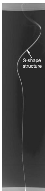
Figura 2.7. Estrutura de vórtice no formato S obtida experimentalmente por Lim e Cui (2005).
