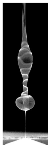
Figura 1.1. Visualização de dois vortex breakdown gerados em laboratório por Lim e Cui (2005).
