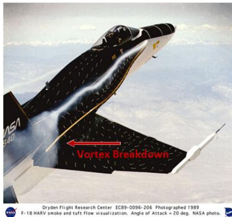
Figura 1.2. Vortex breakdown formado sobre a asa de uma aeronave militar (Gursul, et al., 2003).
