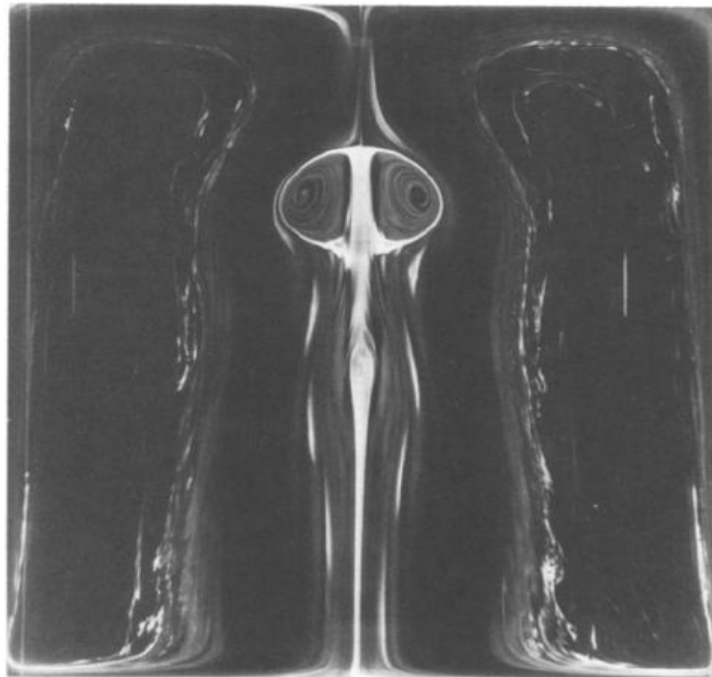
Figura 2.5. Visualização de dois breakdown do tipo bolha (Escudier, 1984).
