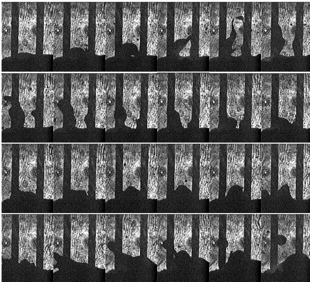
Figura 4.8 – Amostra seqüencial (tempo entre quadros não necessariamente constantes) da transferência metálica em arco curto, com o gás de proteção de Ar + 20% CO<sub>2</sub>, CP 7 e 8
