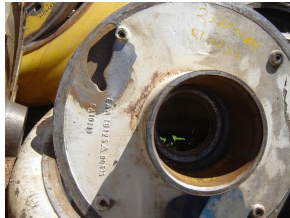
Figura 3.2 - Componentes das bombas de polpa: a) Tampa de sucção; b) Tampa de recalque.
