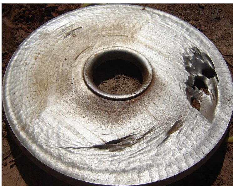
Figura 2.11 - Tampa de sucção de um conjunto de revestimento desgastado da KBM, após 70 dias de uso no bombeamento de polpa.
