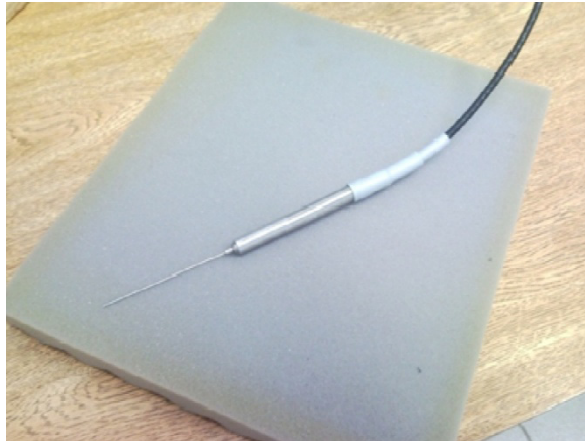
Figura 4.3 – Sonda Hukseflux TP-08 (Fonte: Motta, 2012).
