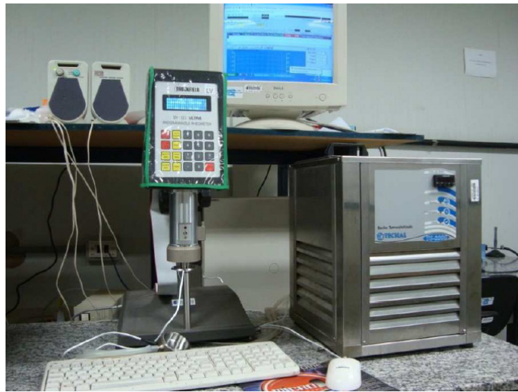
Figura 4.4 – Reômetro utilizados nos experimentos (Fonte: Motta, 2012).
