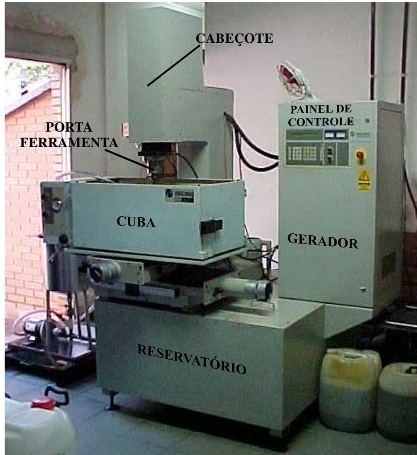
**Figura 4.2- Equipamento EDM por penetração – ENGEMAQ 440 NC**
