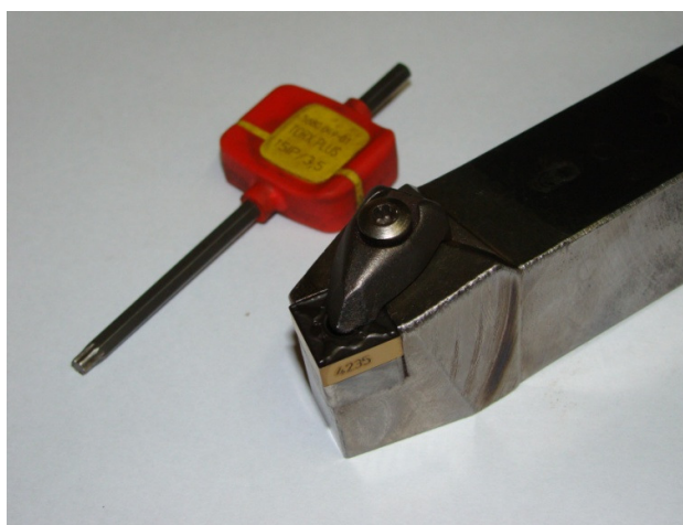
Figura 3.8. Inserto fixado ao suporte pelo método de grampo
