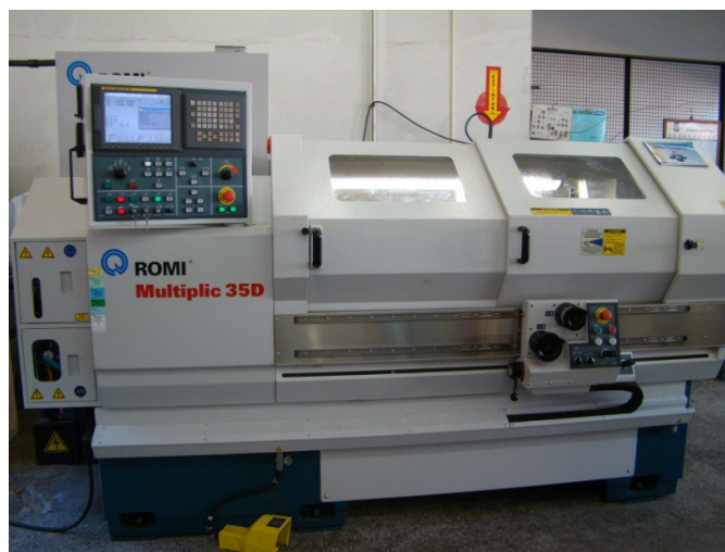
Figura 3.4. Torno CNC Romi Multiplic 35D utilizado nos testes de torneamento
