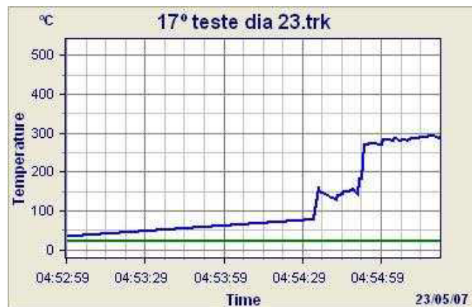
Figura II.17. Sinal de temperatura do cavaco durante o 17º ensaio utilizando V_c = 130 m/min e VB = 0,3 mm
