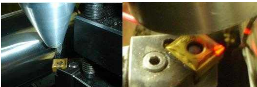
Figura 3.4 – Mira da posição de medida de temperatura do sensor infravermelho
