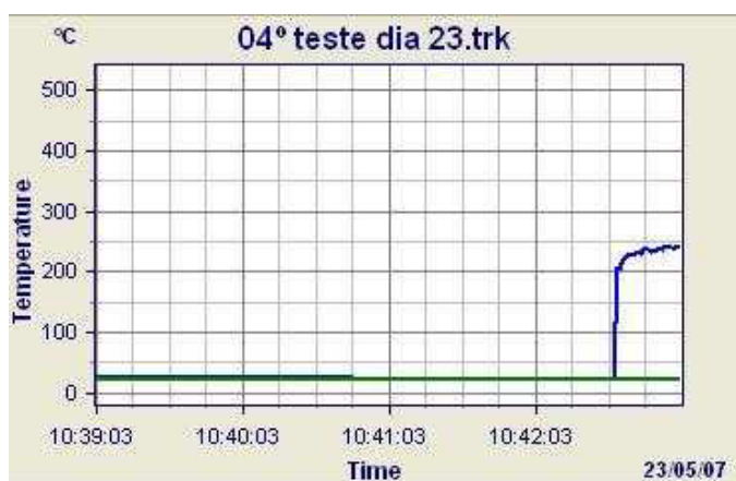
Figura II.4. Sinal de temperatura do cavaco durante o 4º ensaio utilizando V_c = 160 m/min e VB = 0 mm
