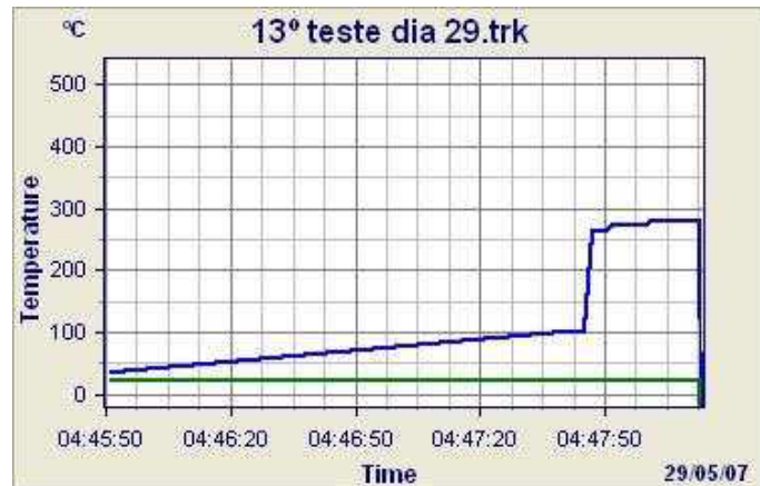
Figura II.13. Sinal de temperatura do cavaco durante o 13º ensaio utilizando V_c = 150 m/min e VB = 0,2 mm
