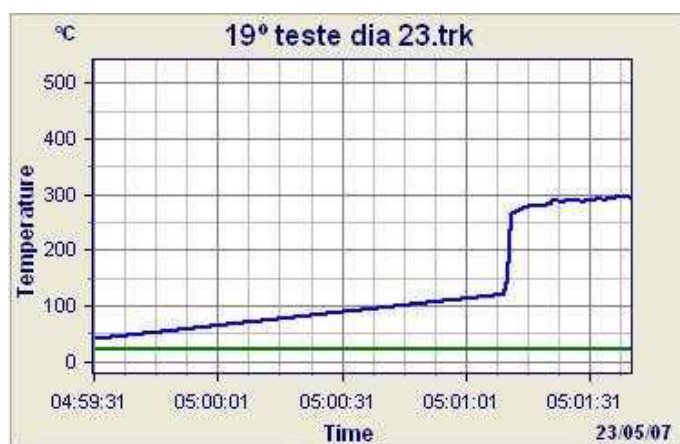
Figura II.19. Sinal de temperatura do cavaco durante o 19º ensaio utilizando V_c = 160 m/min e VB = 0,3 mm
