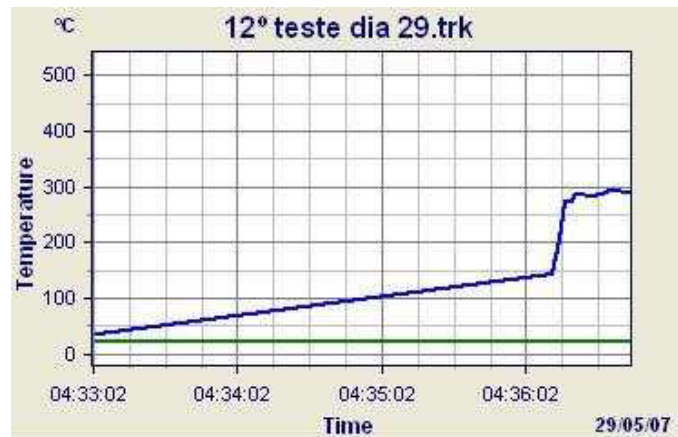
Figura II.12. Sinal de temperatura do cavaco durante o 12º ensaio utilizando V_c = 130 m/min e VB = 0,2 mm
