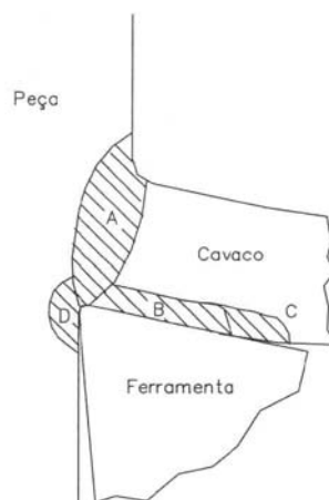
Figura 2.9 – Zonas de geração de calor em usinagem [Machado e Da Silva, 2004]
