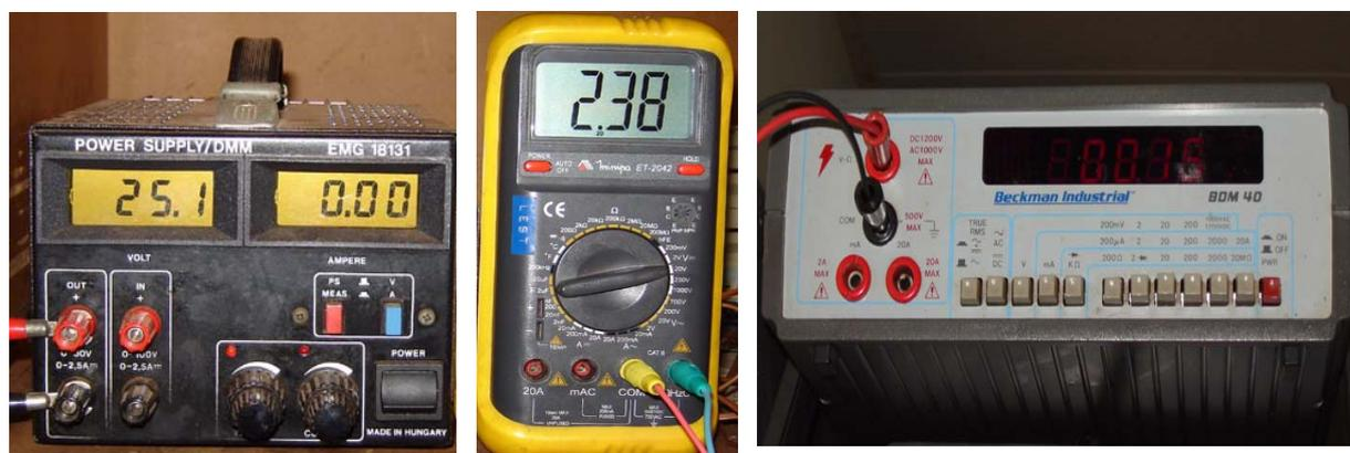
Figura 4.10 – Fonte, voltímetros manual e de bancada
