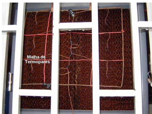
Figura 4.14 – Malha de termopares na entrada do ar no painel do resfriador
