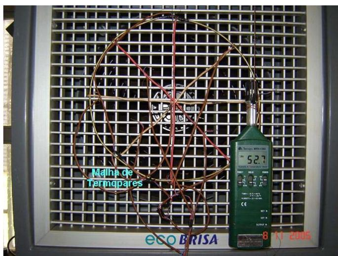
Figura 4.15 – Malha de termopares na saída do ar do resfriador
