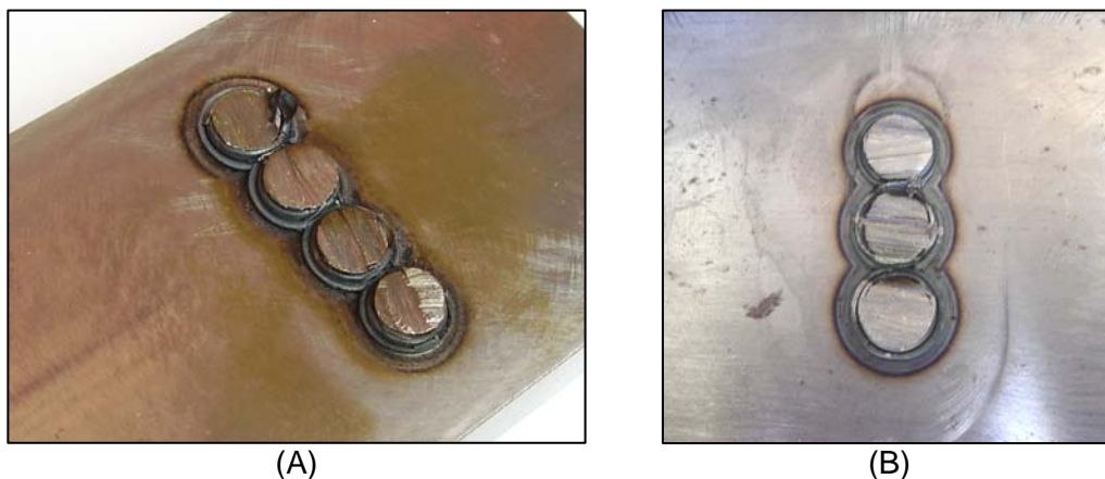
Figura 4.72: Bloco de reparo preliminar, geometria D, após ensaios de preenchimento: (A) primeiro passe; (B) segundo passe de preenchimento.
