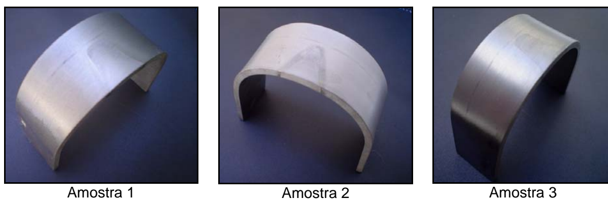
Figura 4.74: Amostras retiradas do bloco de reparo por costura preliminar; imagens realizadas após a realização do ensaio de dobramento transversal lateral.
