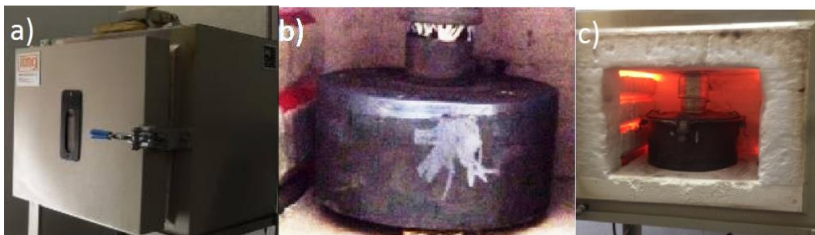
Figura 3.8 – (a) mufla de resistências elétricas; (b) carcaça metálica utilizada no armazenamento da madeira; (c) carcaça no interior da mufla no processo de carbonização da madeira
