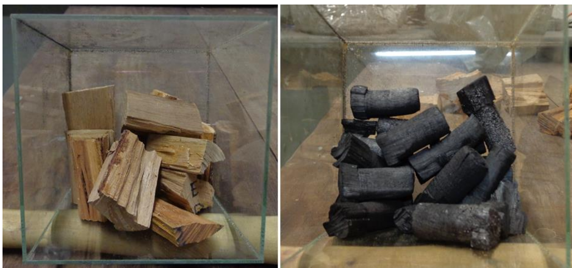
Figura 5.8 – Amostras de madeira prontas para serem enfiadas e posteriormente o carvão resultante do ciclo de carbonização em laboratório
