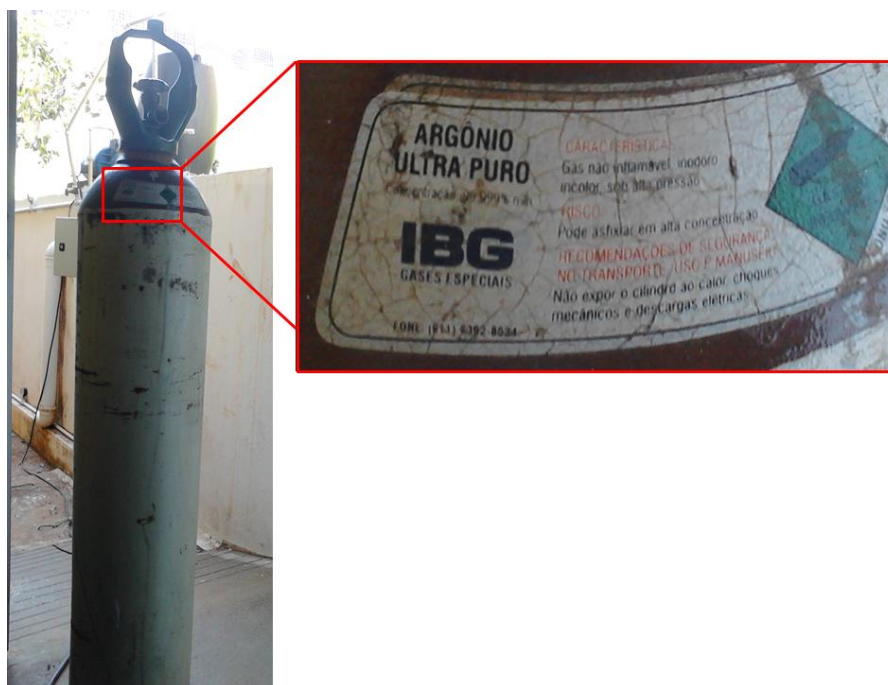
Figura 4.13 – Detalhe da descrição no rótulo do cilindro de argônio ultra puro, concentração volumétrica de 99,999%, no qual foi utilizado para a lavagem dos bags e da microseringa
