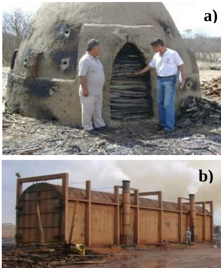
Figura 2.3 – Comparação entre as dimensões dos fornos utilizados pelos pequenos produtores (a) forno rabo-quente (IMOPEC, 2011) e os utilizados pelos grandes produtores de carvão vegetal (b) fornos retangulares – modelo RAC 220
