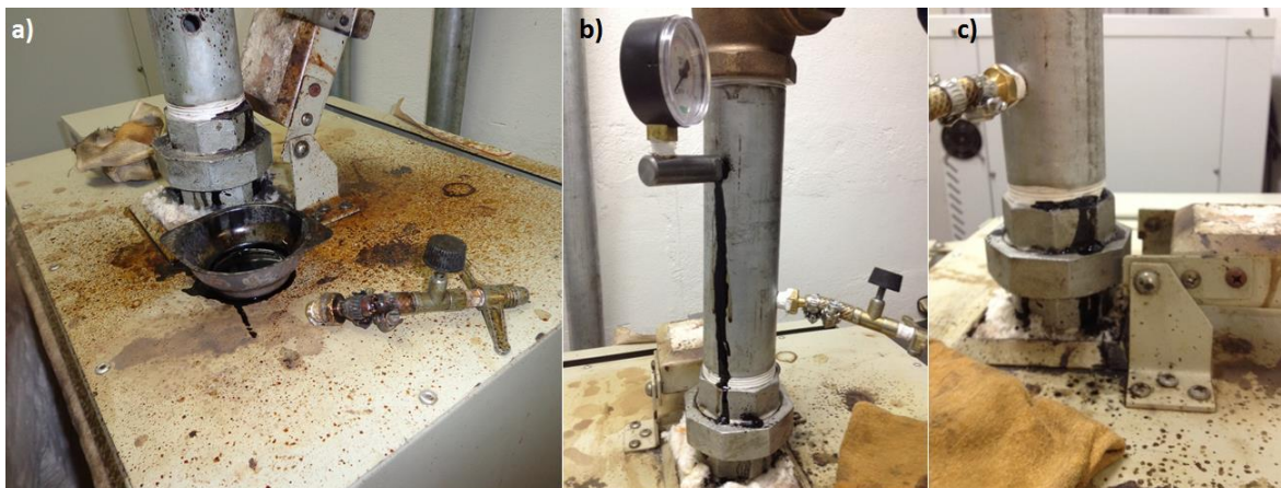
Figura 7.2 – Presença de ácido acético e alcatrão provocando mau funcionamento dos equipamentos
