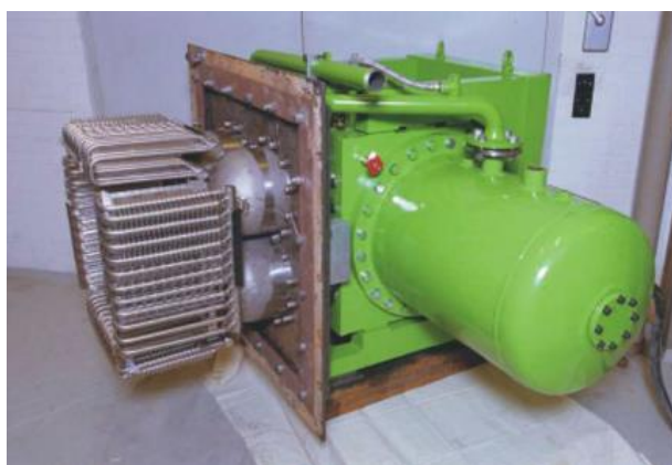
Figura 2.15 – Motor Stirling antes de ser instalado no forno (BIEDERMANN, CARLSEN e OBERNBERGER, 2003)
