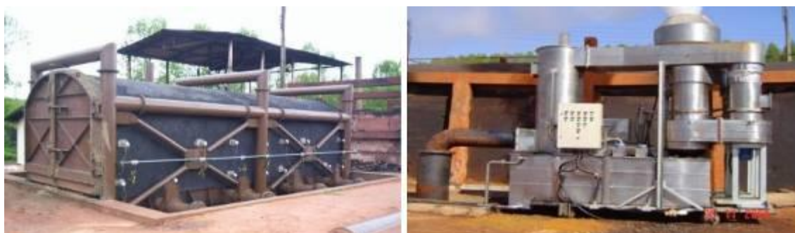
Figura 2.7 – Adaptações em fornos de alvenaria (RAAD, COSTA E WINTER, 2008).
