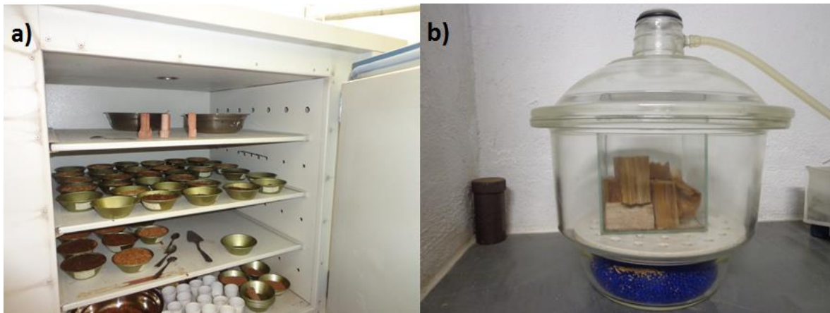
Figura 5.3 – (a) Amostras de madeira sendo secas no interior da estufa; (b) amostras de madeira resfriando dentro do dessecador conforme a norma NBR 8112
