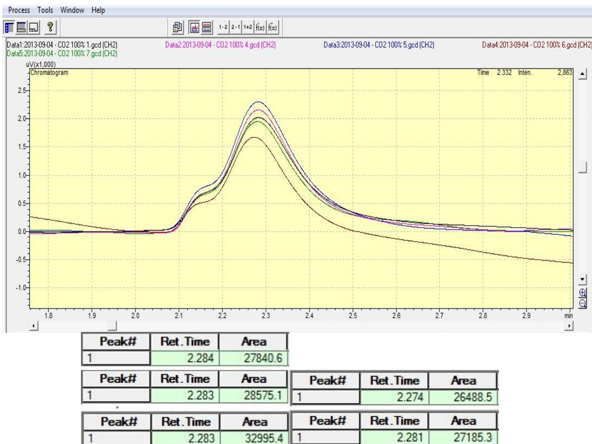
Figura 4.27 – Representação gráfica fornecida pelo aplicativo computacional GC Solutions , para amostras do gás contido em um bag Tedlar com concentração volumétrica de dióxido de carbono a 99,99%, detectada pelo sensor TCD em um mesmo dia de testes
