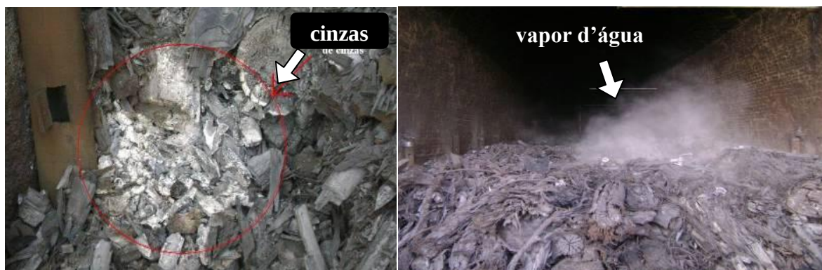
Figura 2.11 – Carvão ainda no interior do forno, e identificação de falhas no processo, frutos de adaptações intuitivas: alta concentração de cinzas e friabilidade elevada devido ao borrifamento de água na etapa de resfriamento do carvão vegetal, respectivamente
