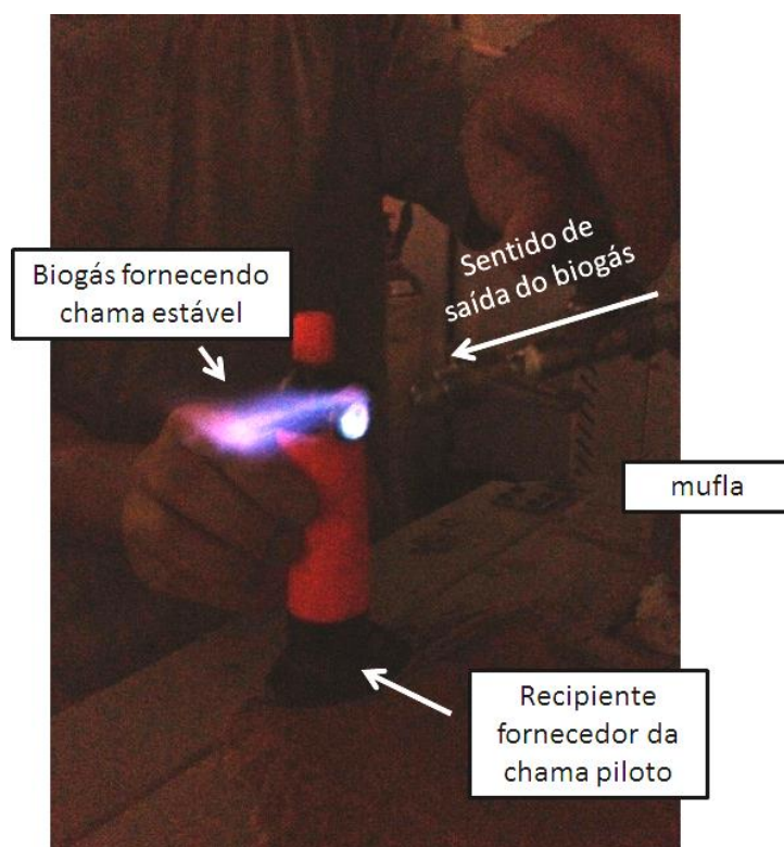
Figura 6.5 – Queima do biogás proveniente da etapa de pirólise da madeira reproduzida em laboratório
