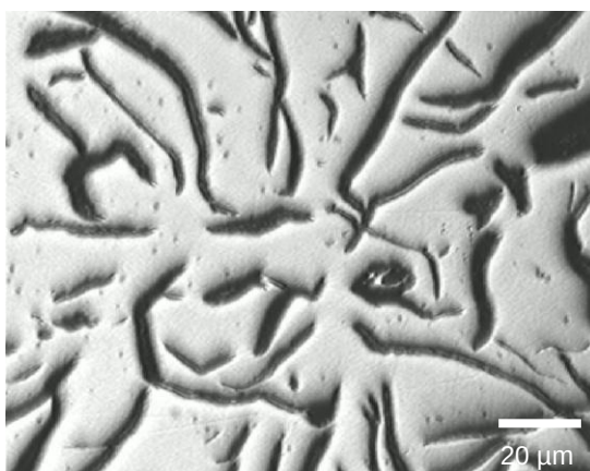
Figura 3.12 - Fotografia ilustrativa da microestrutura do Ferro Fundido Cinzento GH - 190 utilizado nos testes.
