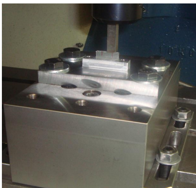
Figura 3.7 - Dispositivo desenvolvido e fixado no dinamômetro.
