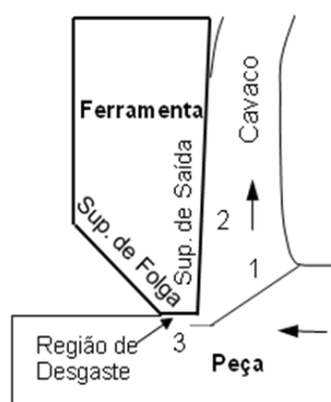
Figura 2.5 - Modelo das três zonas de cisalhamento no corte dos metais (Adaptado de Jacobson e Wallén, 1988).
