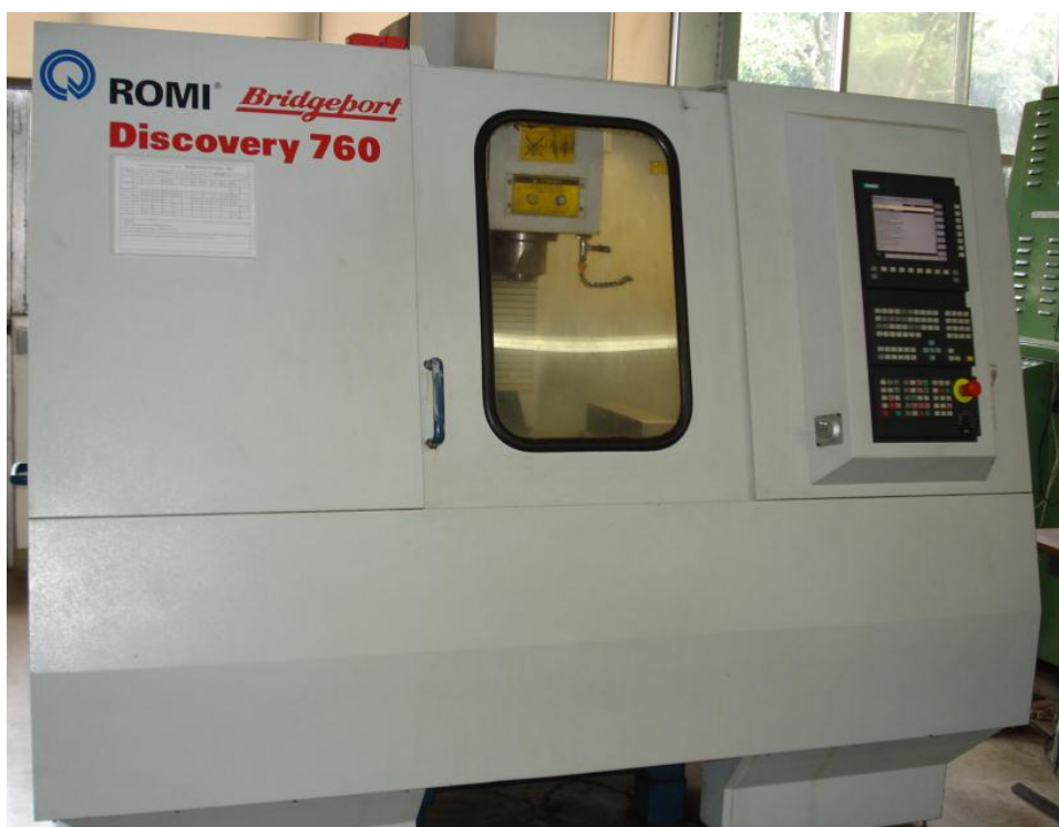
Figura 3.10 - Centro de usinagem vertical CNC utilizado no teste de usinagem no corte ortogonal.
