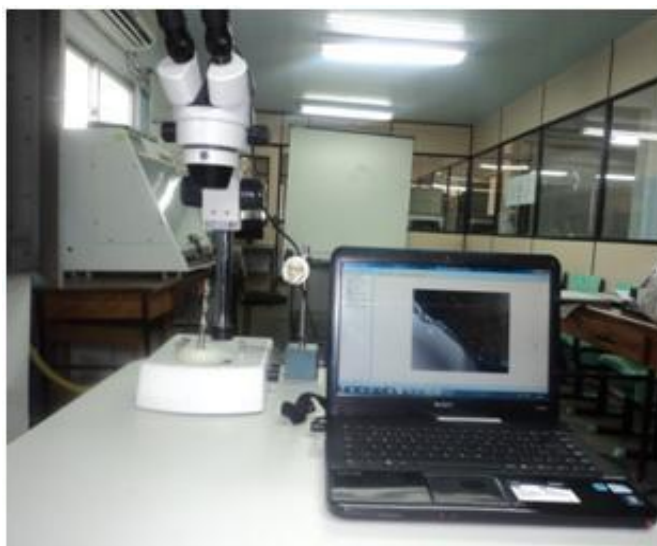
Figura 3.12 - Microscópio triocular para monitoramento do desgaste. Fonte: Elaborado pelo Autor (2013).
