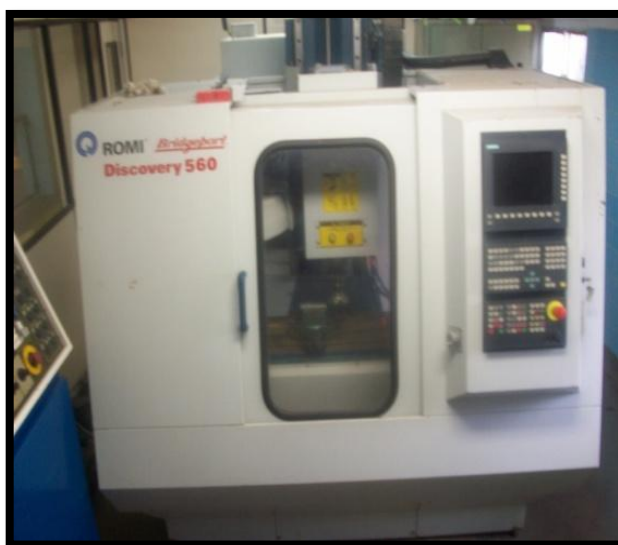
Figura 3.10 - Centro de usinagem vertical, Discovery 560, ROMI. Fonte: Elaborado pelo Autor (2013).
