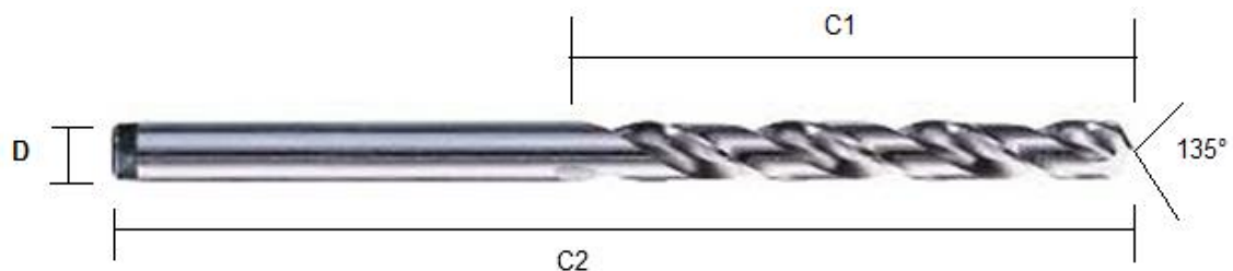
Figura 3.9 Broca para metal HSS-G de 10 mm de diâmetro sem revestimento, DIN 338, C1 = 87 mm, C2 = 133 mm e D = 10 mm. Fonte: Elaborado pelo Autor (2013).
