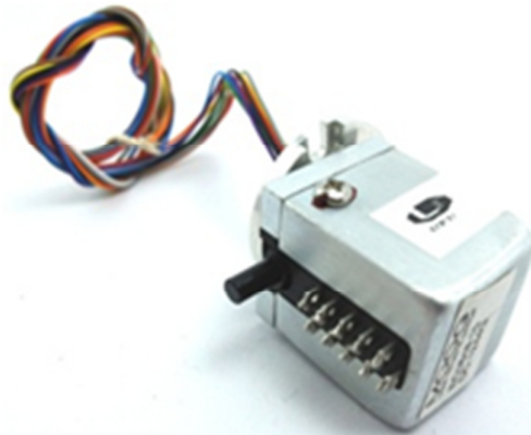
Figura 7.4 – Slip Ring utilizado na aplicação de método da Impedância Eletromecânica com o sistema rotativo em operação.
