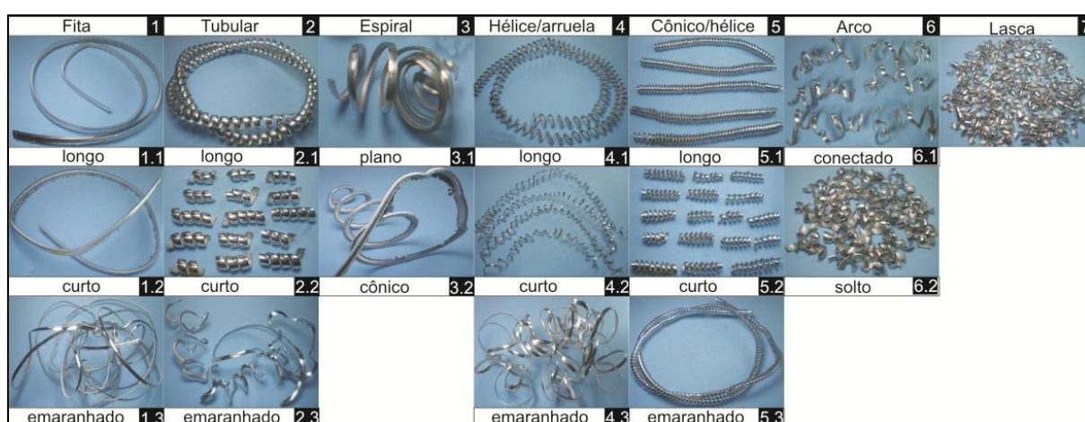
Figura 2.6 – Formas de cavaco (Adaptado da ISO 3685, 1993)
