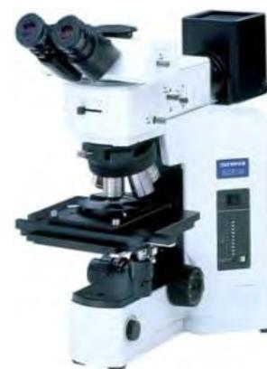
Figura 3.16 - Microscópio óptico utilizado no sistema de medição
