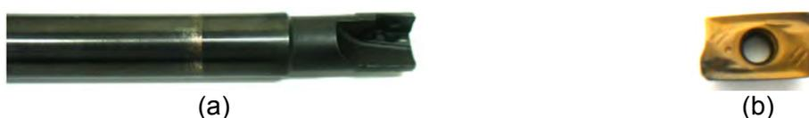
Figura 3.17 - Ferramentas de corte utilizadas na abertura do sulco no CP1. (a) - Fresa de topo, (b) - inserto de metal duro
