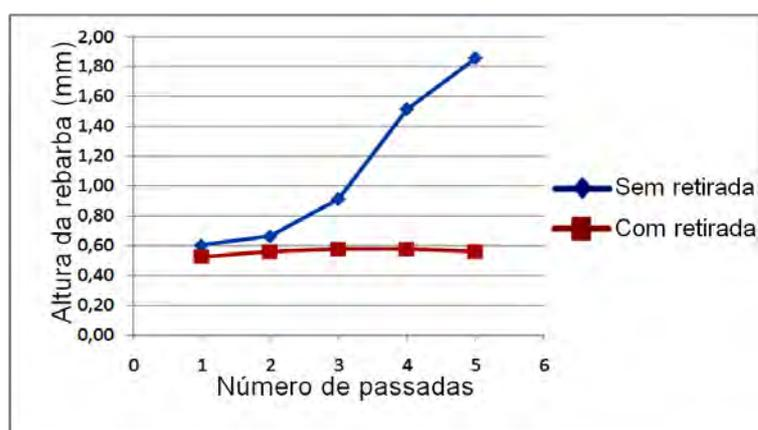
Figura 4.16 - Altura média da rebarba em relação ao número de passadas para retirada da rebarba remanescente e com a rebarba remanescente
