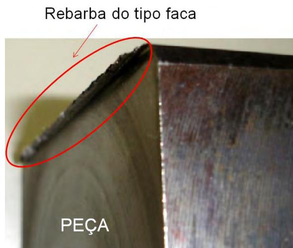
Figura 4.4 – Rebarba do tipo faca, formada na borda de entrada da peça e observadas em todas as peças após os ensaios
