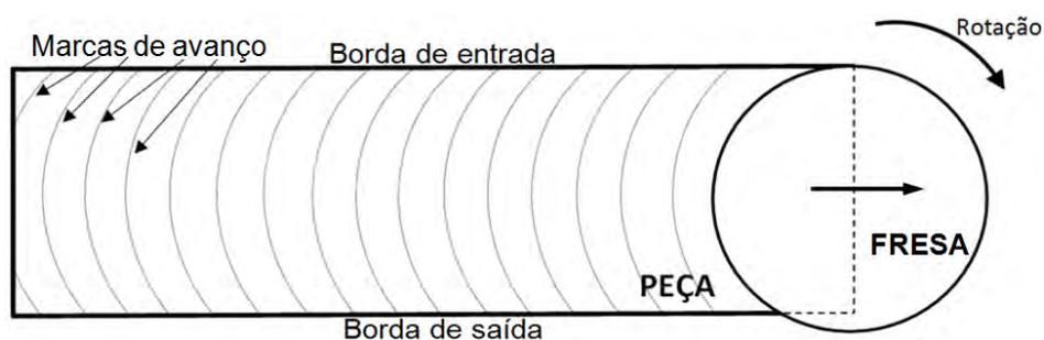
Figura 4.2 – Esquema ilustrando as marcas de avanço formadas após a recuperação elástica do material
