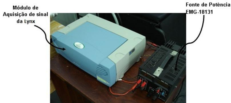
Figura 3.26- Fonte de alimentação do sensor e aquisitor de sinais da Lynx.
