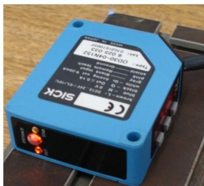
Figura 3.25- Sensor a laser SICK usado para fazer a medição dos deslocamentos nos dois ramos da mandíbula.
