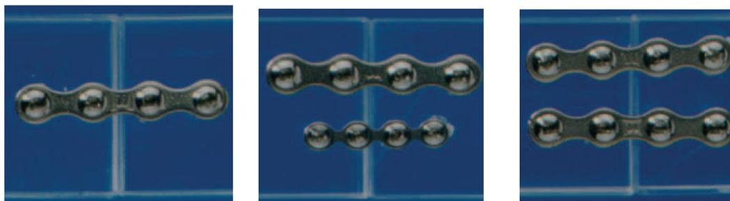
Figura 2.15- Configurações analisadas por Feller et al. (2002) com uma miniplaca, uma miniplaca e uma microplaca e duas miniplacas.
