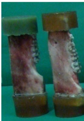
Fig. 3.13- Corpos-de-prova de blocos de osso prontos para os ensaios experimentais com miniplacas.
