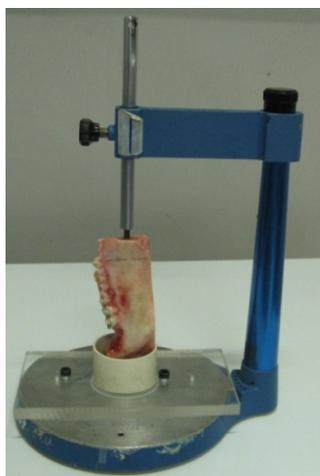
Figura 3.11- Dispositivo de fixação do bloco para confecção da base de resina nas extremidades.
