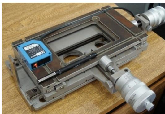
Figura 3.29- Aparato para fazer as medições para reta de calibração do sensor a laser.
