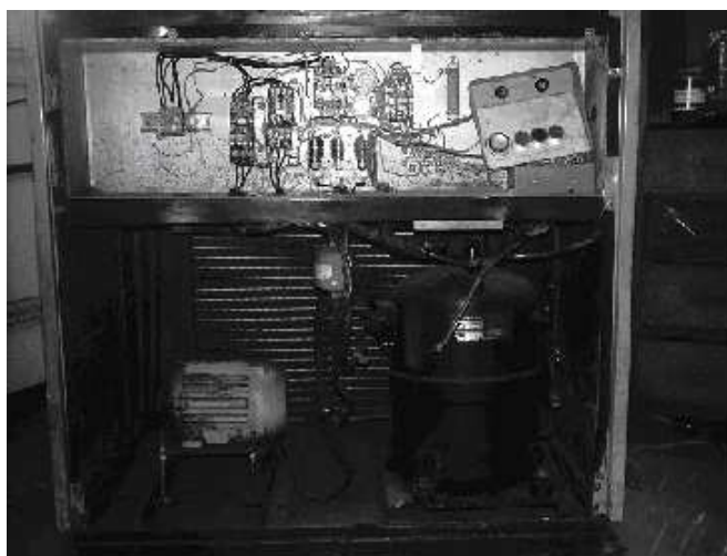
Figura 3.2 - Fotografia do aparelho de ar condicionado tipo self-contained da marca Hitachi, utilizado inicialmente na presente pesquisa.
