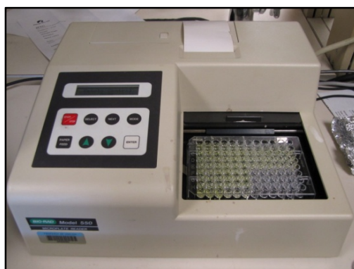
Figura 4.30 – Espectrofotômetro utilizado na obtenção da medida de ALP.
