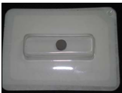
Figura 4.13 – Disco de titânio embalado separadamente para evitar contaminação e pronto para o uso.
