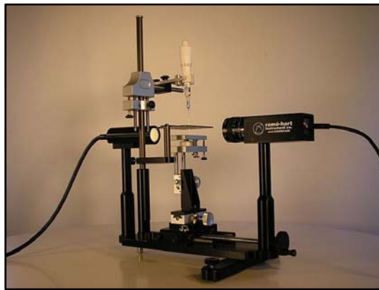
Figura 6.17 – Goniômetro utilizado para obter as imagens para o cálculo do ângulo de contato (OURA et al., 2003).
