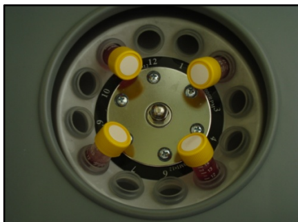
Figura 4.17 – Tubos “Falcon” posicionados dentro da centrífuga.
