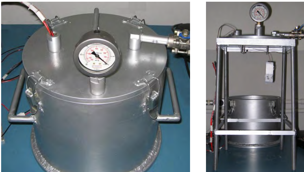
Figura A2. Câmara de vácuo usada para garantir isolamento térmico nas superfícies sem contato entre amostra e aquecedor e expostas ao meio externo.
