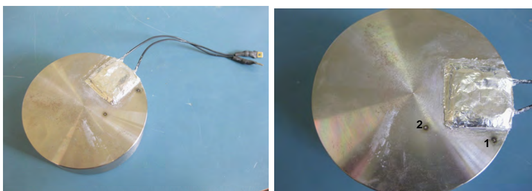
Figura 5.18 – Peça, aquecedor resistivo e posição dos termopares.
