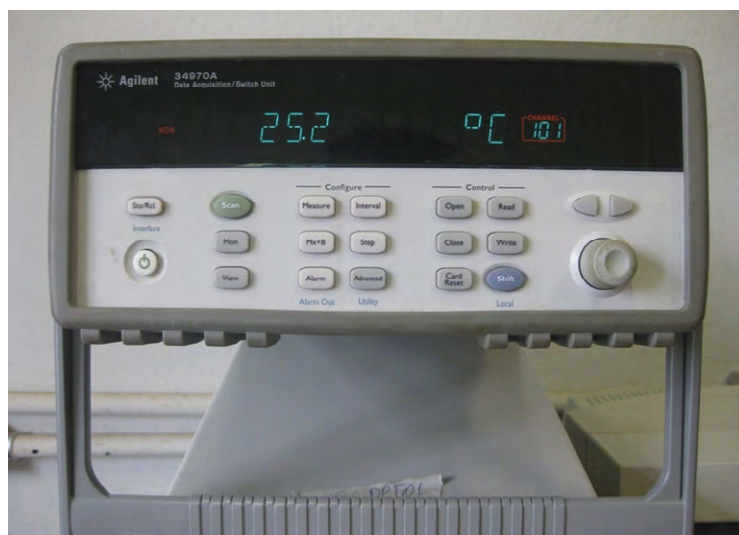
Figura 5.23 - Sistema de aquisição de dados Agilent 34970A.
