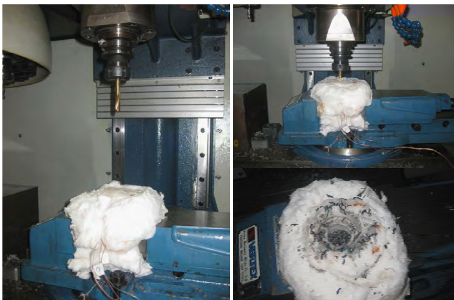
Figura 5.46 – Montagem experimental com isolante térmico.
