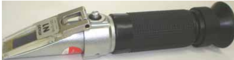
Figura 4.21 – Refratômetro para medição da concentração do fluido de corte
