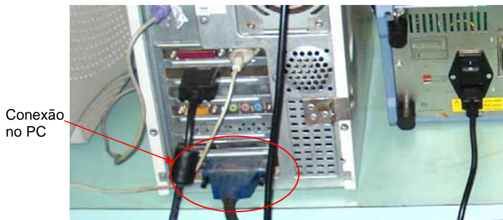
Figura A2.11 – Verificação da ligação do cabo na placa de aquisição de sinais do computador
