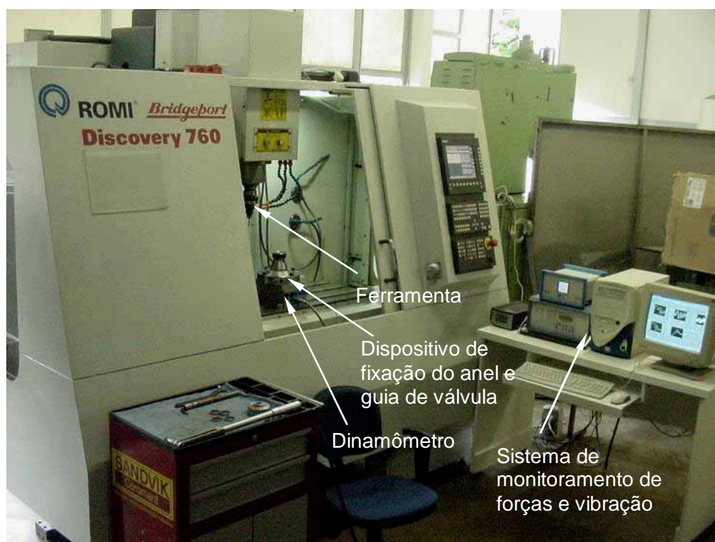
Figura 4.3 – Centro de usinagem vertical ROMI® utilizado nos ensaios
