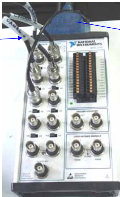
Figura A2.10 – Montagem dos cabos BNC no bloco conector de sinais
