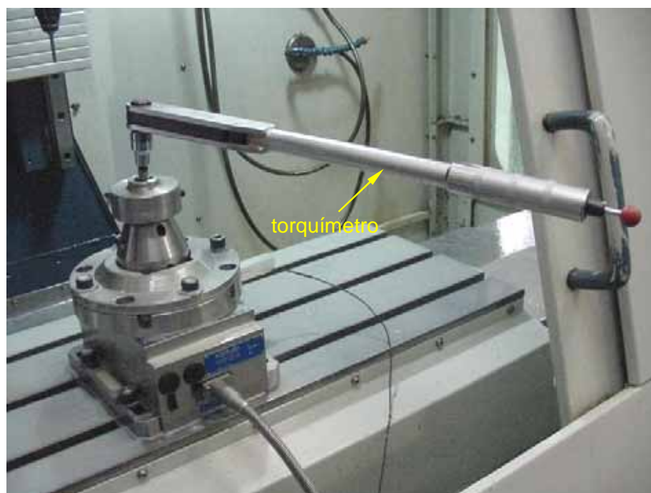
Figura 4.15 – Fixação do anel (sede de válvula) com um torquímetro
