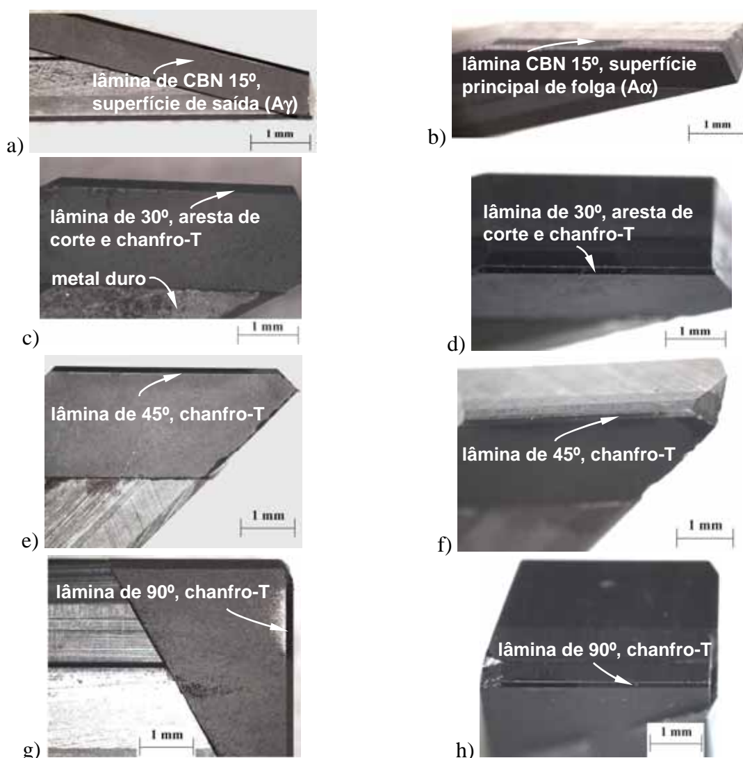
Figura 5.6 – Detalhes da geometria da cunha cortante e chanfro-T do jogo de lâminas de PCBN utilizadas nos testes de usinagem das sedes de válvulas; (a), (c), (e) e (g) vista superior; (b), (d), (f) e (h) vista de topo das respectivas lâminas
