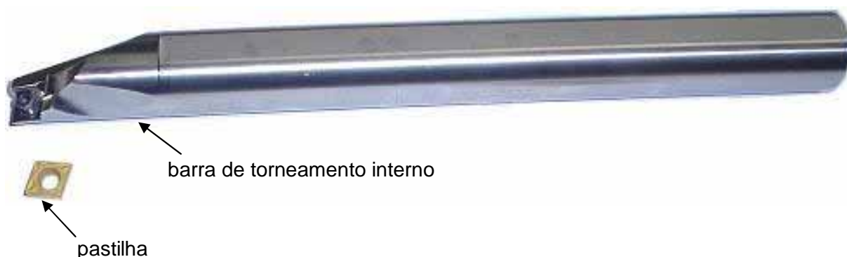
Figura 4.12 – Barra de torneamento interno e pastilha utilizada na operação de torneamento cilíndrico interno dos anéis (sedes de válvula)
