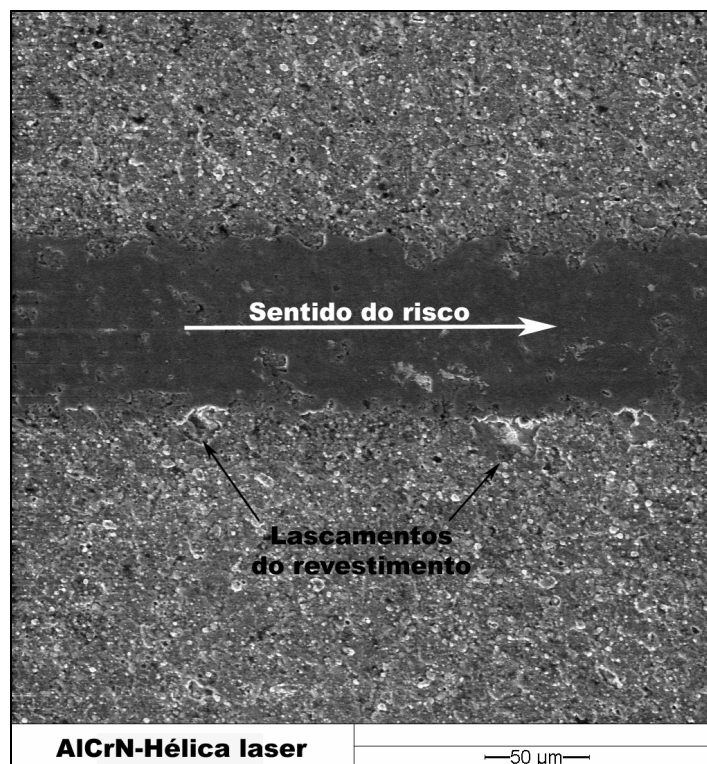
Figura 4.75 - Pontos isolados de lascamento do revestimento AlCrN-Hélica laser antes do final do risco.
