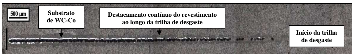
Figura 4.65 - Trilha de desgaste para a ferramenta AlCrN-Alcrona jateada.
