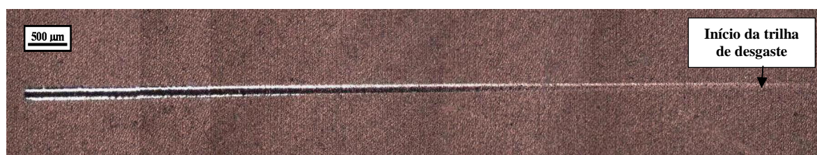
Figura 4.63 - Trilha de desgaste para a ferramenta AlCrN-Hélica laser.
