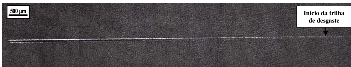
Figura 4.66 - Trilha de desgaste para a ferramenta AlCrN-Alcrona laser.
