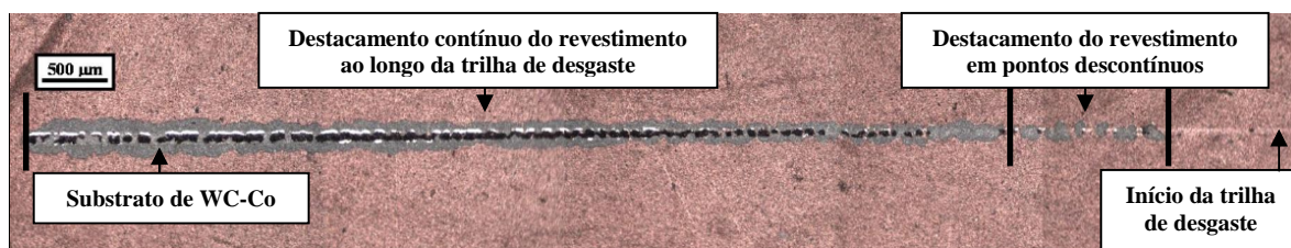
Figura 4.62 - Trilha de desgaste para a ferramenta AlCrN-Hélica jateada.
