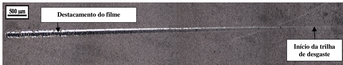
Figura 4.68 - Trilha de desgaste para a ferramenta TiAlN-Futura jateada.
