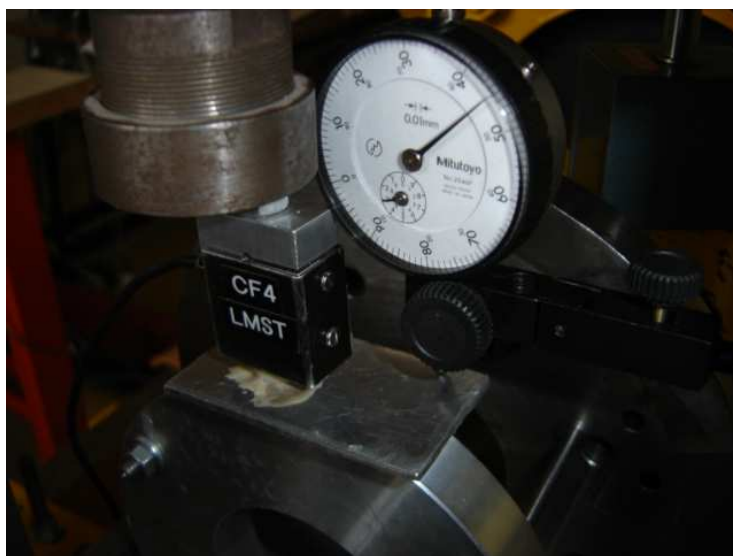
Figura 5.4 - Aparato do ensaio de deformação estática do conjunto hastes-disco.
