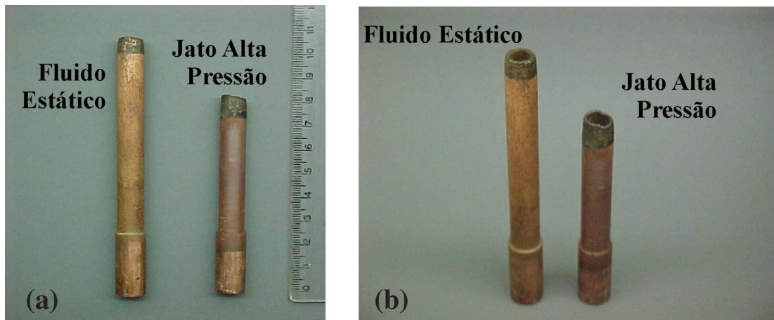
Figura 5.8. Desgaste das ferramentas nos ensaios com água deionizada e com adição de abrasivo: (a) vista 1 e (b) vista 2.
