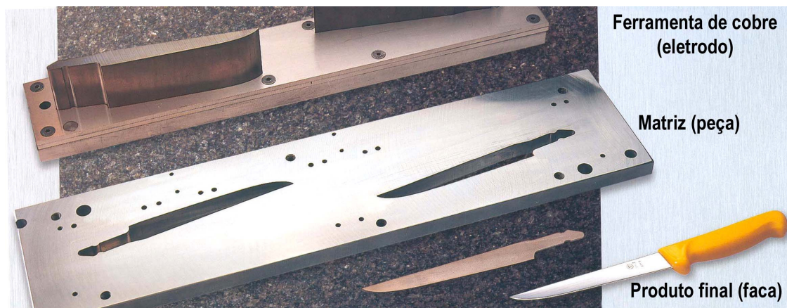
Figura 2.5. Eletrodo de cobre, matriz e faca de cozinha (CHARMILLES, 2006).
