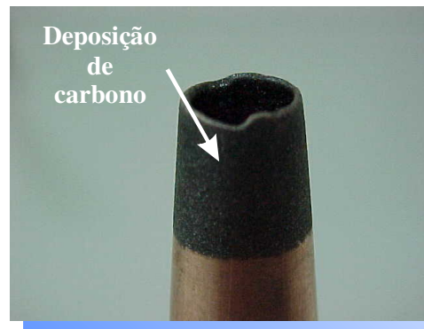
Figura 2.17. Deposição de carbono na ferramenta de cobre (ARANTES, 2001).
