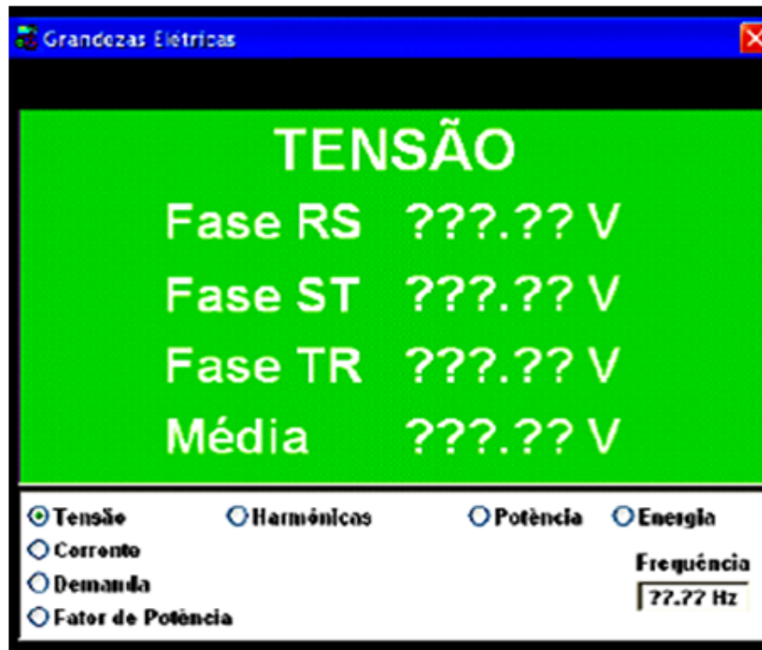
Figura 3.26 – Janela de medições de grandezas elétricas
