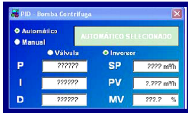
Figura 3.31 – Janela PID do sistema de bombeamento
