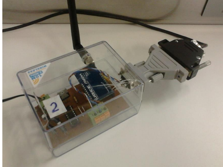
Figura 20 - Placa de comunicação finalizada conectada à porta serial RS-232 da planta.
