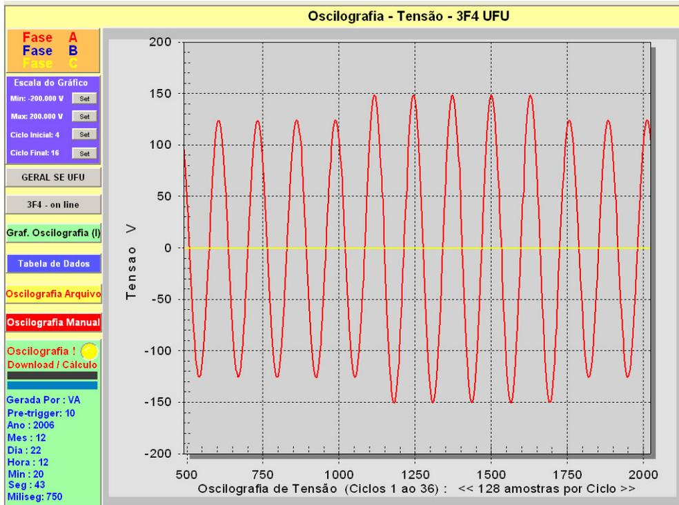
Figura 5.5 - Ensaio Oscilografia (Sobretensão – 12 ciclos) – sistema OOL.
