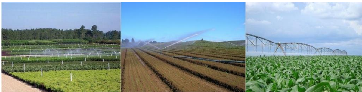
Figura 2.2: Exemplos de sistemas por aspersão com linha lateral: fixas (esquerda) portáteis (centro) e pivô central (direita).
