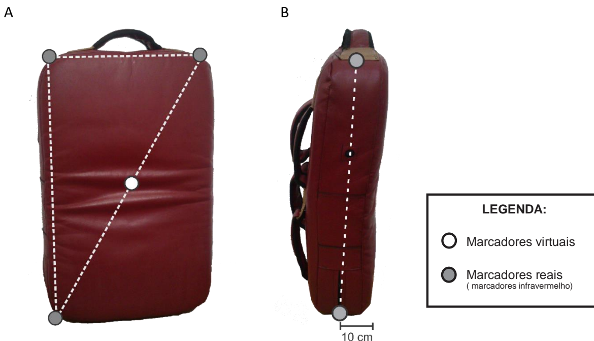
Figura 22 – A) Representação do posicionamento dos marcadores reais e virtuais sob uma vista frontal do aparador; B) Representação do posicionamento dos marcadores sob uma vista lateral do aparador, nesta vista é possível identificar a largura do mesmo que deve ser descontada no momento do processamento dos dados.
