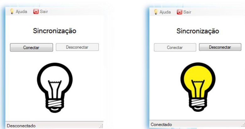
Figura 15 – Interface desenvolvida no software de eletromiografia sem fio com o objetivo de permitir o acendimento do LED pelo usuário, de forma a iniciar o sincronismo entre os sistemas.
