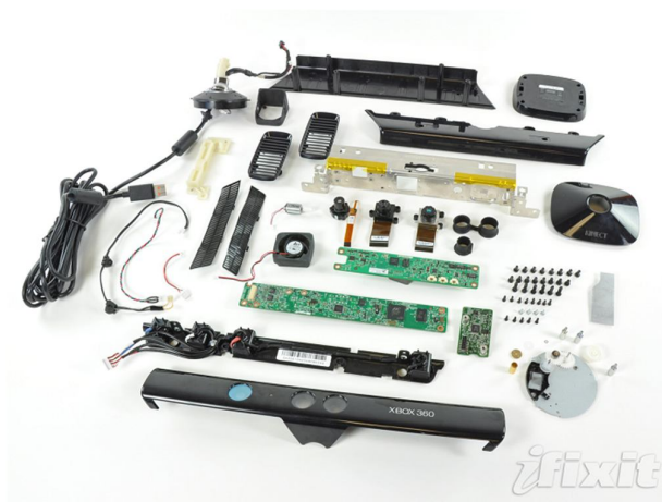
Figura 31 - Kinect Desmontado (IFIXIT, 2012)
