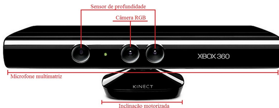
Figura 13 - Sensor Kinect® (baseado em MICROSOFT 2011)
