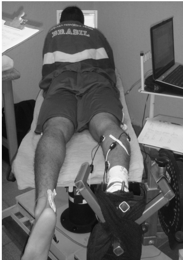
Figura 4.1 – Imagem ilustrativa do processo de coleta dos sinais eletromiográficos e de torque utilizados no experimento.
