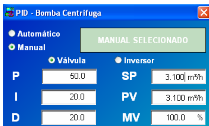
Figura 3.12 – Janela de PID do sistema de bombeamento
