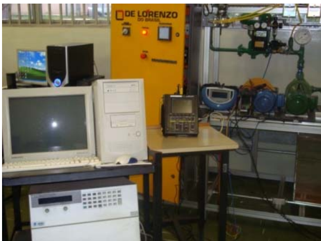
Fig. 1. Sistema de bombeamento – bancada de ensaios.
