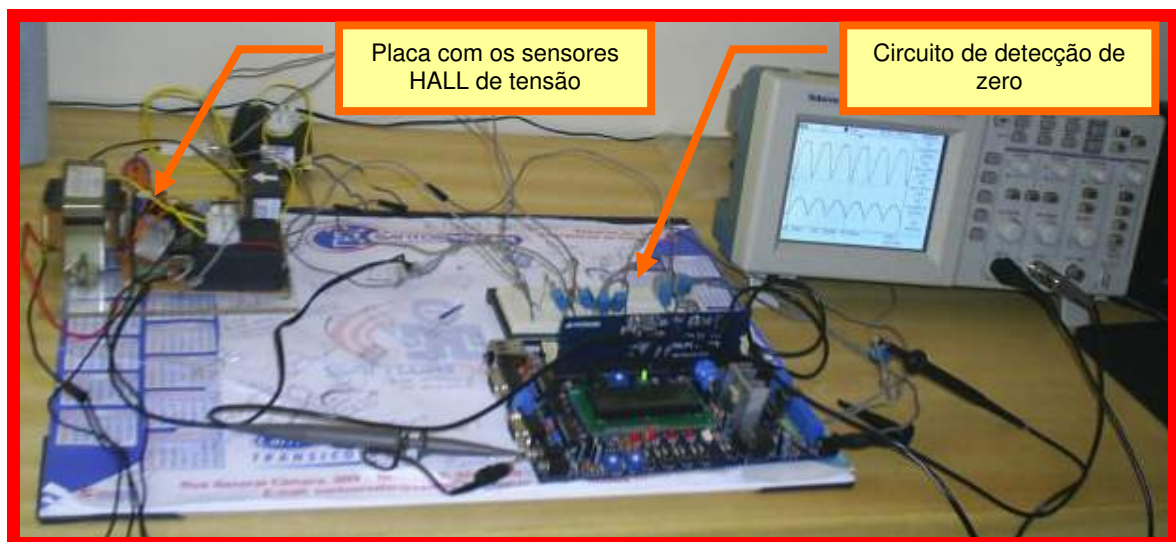
Figura 4.3. Testes Iniciais com o Sistema de Supervisão da Rede Elétrica com o LPC2138.
