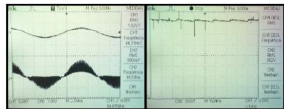
Figura 5. Formas de onda da tensão e corrente na entrada_90Vca e Forma de onda da tensão de saída_382Vcc
