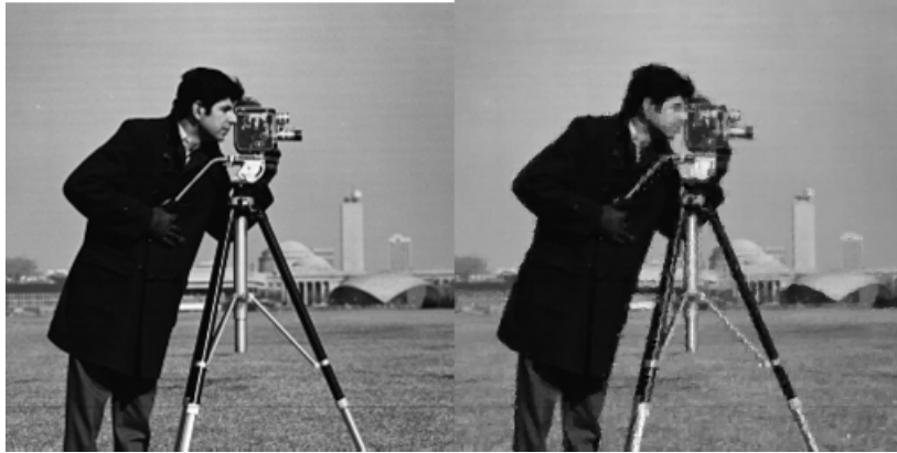
Figura 3.13: Imagem original Cameraman e imagem recuperada a 0,19 bpp com \text{PSNR} = 26,83 dB.
