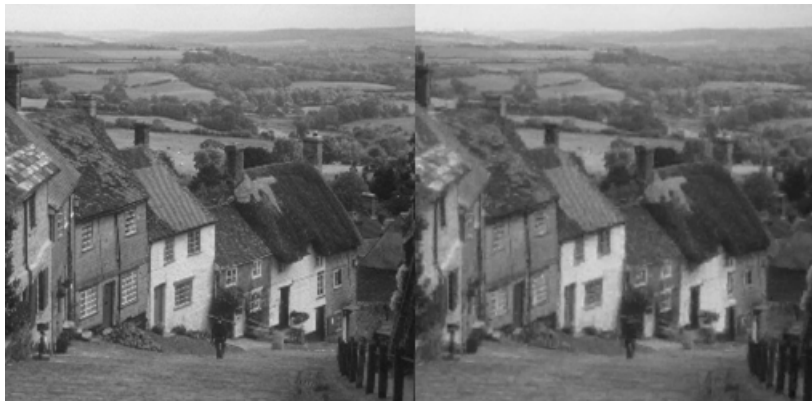
Figura 3.8: Imagem original Goldhill e imagem recuperada a 0,19 bpp com PSNR = 28,73 dB.
