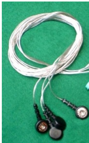
Figura 2.11: Exemplo de eletrodos passivos para a detecção de sinal EMG de superfície [7].
