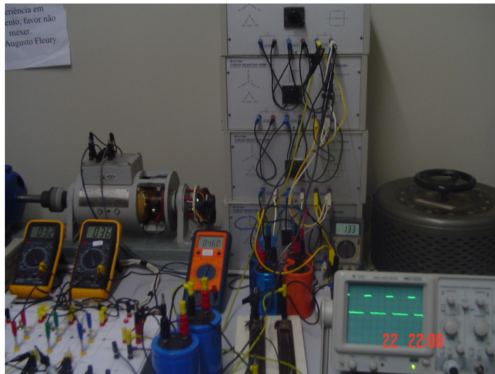
Fig. 5.5 – Caixas de resistências e osciloscópio mostrando o sinal de disparo das chaves em uma das fases.
