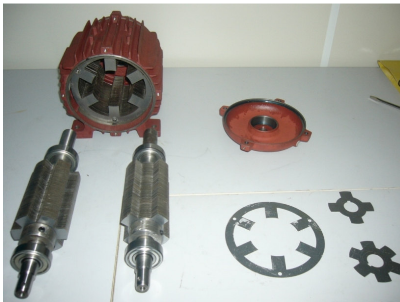
Fig. 5.21 – Partes da máquina antes do enrolamento das fases.
