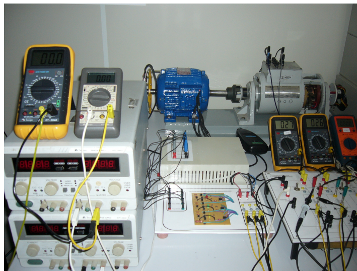
Fig. 5.6 – Protótipo para testes, fontes cc para excitação e fonte para circuito de chaveamento.
